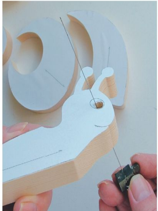
OBEN Das Sägeblatt wird durch ein Bohrloch geführt, um einen Innenschnitt auszuführen.
