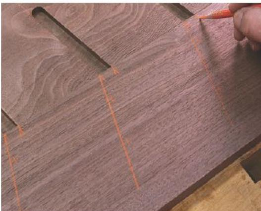
Am besten lassen sich die schrägen Nuten auf den beiden Seiten der Trennwand anreißen, indem man ihre Position von den Seitenwänden abnimmt.
