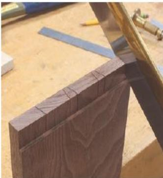
Eine breite Zinke an der Hinterkante des Deckels bietet genügend Platz für die Enden der Fälze an den Seiten, ohne dass die Fälze von außen sichtbar sind.
