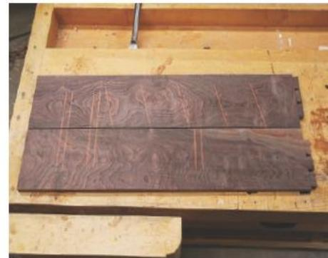
Die Nuten sitzen nicht an den gleichen Stellen der beiden Seitenwände. Arbeiten Sie beim Anreißen entsprechend sorgfältig.
