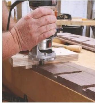
Eine zweite einfache Führung – die im Winkel angesetzt wird, der für den zweiten Satz Nuten genau umgekehrt wird – wird für die schrägen Nuten in den Regalböden für die Fräser verwendet.
