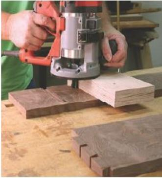
Die geraden Nuten werden mit einem Nutfräser mit Kugellager an einer einfachen Führung geschnitten.
