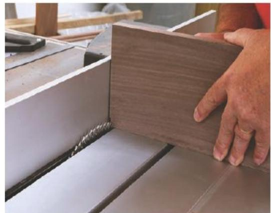
Bis auf die Regalböden für die Fräser müssen alle Teile, die in die Nuten eingelegt werden, an den Enden ausgeklinkt werden. An der Tischkreissäge ist das eine einfache und saubere Arbeit.
