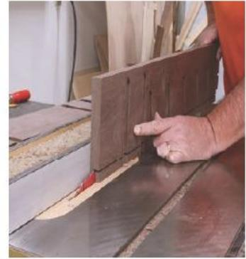
Fälze lassen sich mit zwei einfachen Schnitten an der Tischkreissäge herstellen: Zuerst liegt das Material mit der Fläche auf, dann wird es hochkant am Anschlag geführt.
