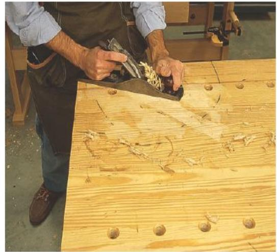
Die harte Arbeit beim Abrichten der Hobelbank leistet man mit der Kurzraubank, mit der man höher liegende Stellen schnell abtragen kann. Meine Hobelbänke scheinen immer in der Mitte tiefer zu werden (zu schüsseln), wie man das auch von Schleifsteinen kennt. Ich beginne deshalb mit dem Abrichten immer an den Längskanten.
