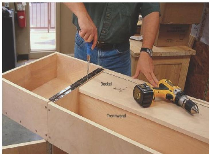
Zuerst wird der Deckel angebracht, dann die Ausleger. Diese schließen bündig mit dem Vorderteil ab und sitzen dicht an den Korpusseitenwänden. An dem zurückspringenden Seitenteil des Auslegers wird das Klavierband so angebracht, dass der Deckel bündig mit dem Korpusoberteil schließen kann.
