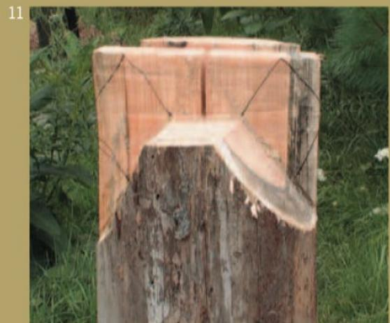
11 Zeichnen Sie die Ohren an, um sicherzustellen, daß sie die gleiche Form und Position haben. Die Markierung dient Ihnen auch als Führung für die Schnitte.
