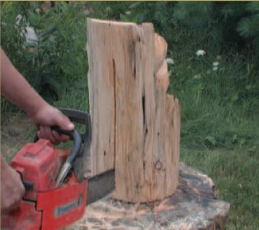
Wenn Sie mit den Strukturierungsarbeiten fertig sind, bringen Sie an der Rückseite des Stammes einen Schnitt an, um das Reißen des Holzes zu kontrollieren.
