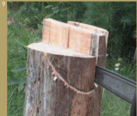
9 Verlängern Sie die den vorderen Ohrenschnitt bis hinunter zum Schnitt, den Sie in Schritt 8 angelegt haben. Achten Sie darauf, nicht über diesen Schnitt hinaus zu schneiden.
