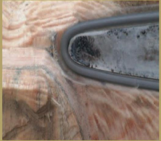
Das Schneiden der Augen erfordert eine sichere Hand. Schneiden Sie mit hoher Geschwindigkeit, und lassen Sie sich Zeit.
