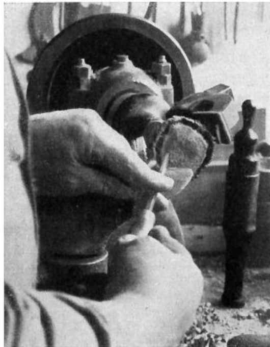
Abb. 680. Abdrehen des Kerns der Krone eines Rehgeweihs im Hornfutter mit einem Schrotstahl
