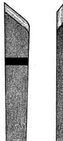
Abb. 107. Flachstahl mit abgerundeter unterer Spitze zum Schlichten von Querholz (von Stuhlsitzen) \frac{1}{2} nat. Größe
