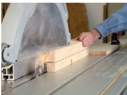
Müssen tiefe und breite Falze hergestellt werden, ist die Formatsäge genau das Richtige. Der Abschnitt kann sogar noch weiter genutzt werden.
