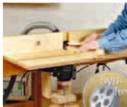
253 Mobiler Frästisch für die Hobelbank
