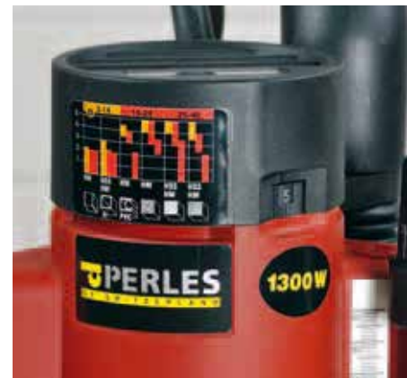
Am Motorgehäuse befindet sich ein Drehrad zur Einstellung der Drehzahl. Einige Hersteller kleben solche Diagramme auf das Gehäuse, auf denen man die zum Werkstoff, Fräserdurchmesser und Fräsermaterial (HSS od. HM) passende Einstellung ablesen kann. Diese Werte sollten Sie aber nur als grobe Anhaltspunkte ansehen, da die tatsächliche Drehzahl nur über eine Probefräsung ermittelt werden kann.
