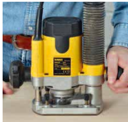
Testen Sie vor dem Kauf der Oberfräse unbedingt die Leichtgängigkeit der Hubsäulen. Bei einer hochwertigen Säulenführung lässt sich der Motor nach Lösen der Arretierung ganz leicht mit nur einer Hand nach unten drücken.
