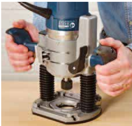
Stärker motorisierte Oberfräsen werden in der Regel mit großen Griffhörnchen ausgestattet, um eine bessere Kontrolle über die höhere Leistung zu erhalten.
