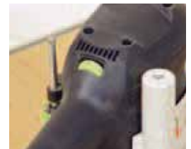
36 Bestimmen und Einstellen der optimalen Drehzahl
