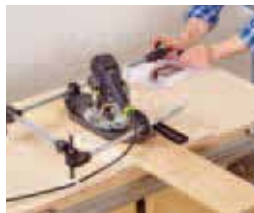
130 Storchenschnabel (Panto- graph) für die Oberfräse
