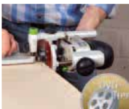
99 Arbeiten mit der Umleimerplatte
