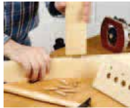
144 Runddübel mit der Oberfräse einbohren – die Dübelscha- blone
