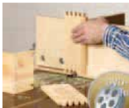
242 Fingerzinken auf dem Frästisch
