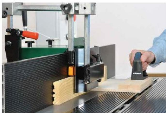
Üppige Profilierungen in nur einem Arbeitsgang sind die Domäne einer Tischfräse. Dabei können Sie nicht nur die Werkstückkanten, sondern auch (je nach Anschlaghöhe) Brettflächen bearbeiten.
