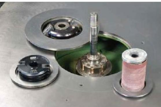
Der Arbeitstisch kann mit den passenden Einlegeringen genau auf den Werkzeugdurchmesser abgestimmt werden. Das erhöht nicht nur die Sicherheit beim Fräsen, sondern verbessert auch maßgeblich das Absaugergebnis.
