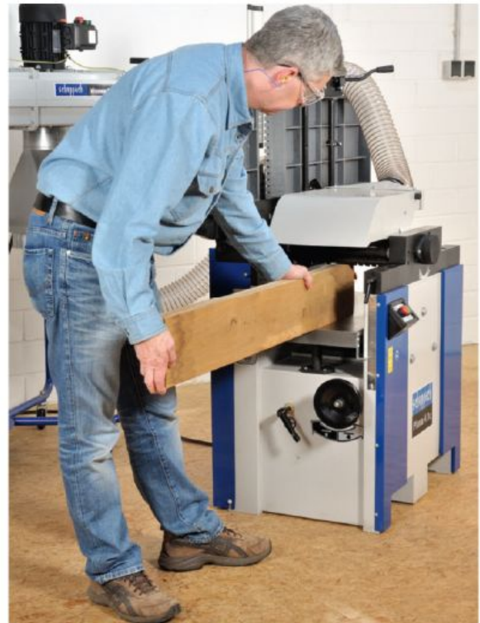
Anschließend können die Bretter dann auf der Dickenhobelmaschine (Dicke) präzise auf ein bestimmtes Dicken- und Breitenmaß gebracht werden.
