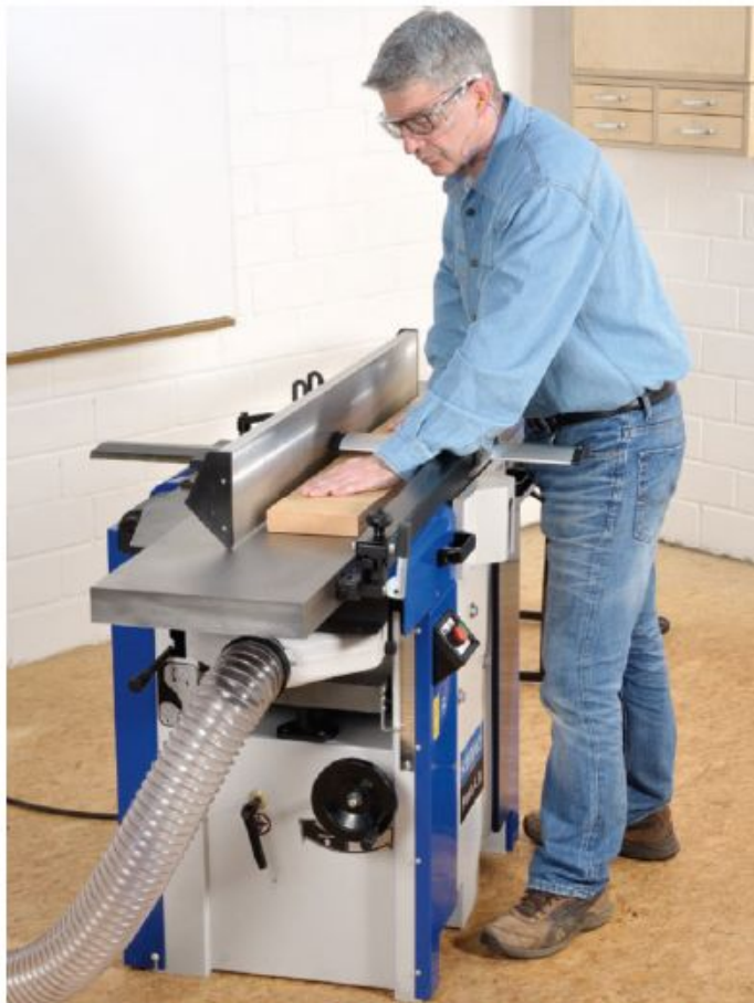
Auf der Abricht- und Dickenhobelmaschine (Abrichte) lassen sich Brettflächen und -kanten im Handumdrehen plan und rechtwinklig zueinander aushobeln.
