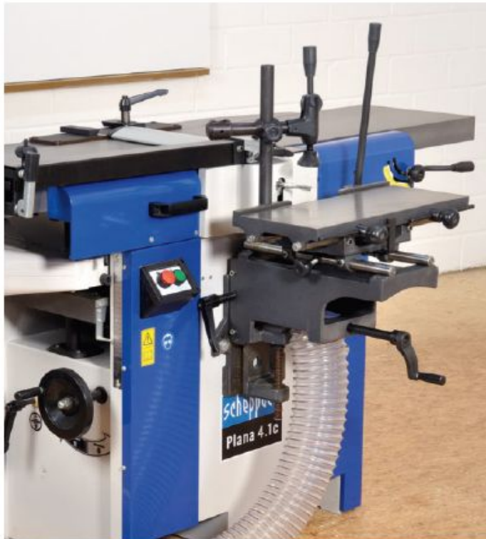
Eine Anbau-Langlochbohr-einrichtung mit auf zwei Achsen beweglichem Arbeitstisch. Möchten Sie die Maschine wieder zum Hobeln einsetzen, dann müssen Sie vorher die Langlochbohr-einrichtung abbauen.
