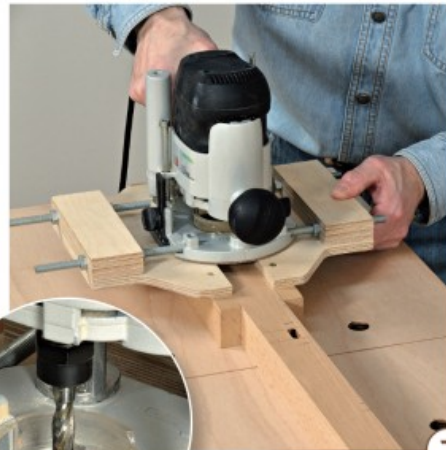
7 > Mit der Oberfräse, einem 8-mm-Nutfräser und einem selbstgebauten doppelten Parallelanschlag können Sie die Zapfenlöcher sehr einfach und äußerst präzise ausfräsen. Fehlfräsungen sind bei dieser Methode quasi ausgeschlossen. Die runden Ecken zum Schluss mit dem Stechbeitel eckig nachstemmen.
