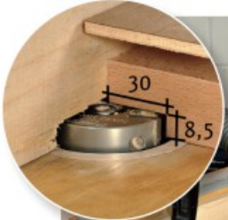
9 > Auf dem Frästisch fräsen Sie anschließend mit dem Queranschlag zuerst die lange Zapfenfläche heraus (kleines Bild). Mit einem großen Falzkopf erzielen Sie eine extrem saubere Zapfenfläche.
