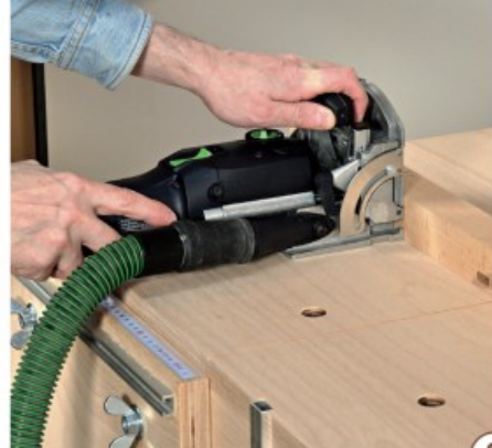
8 > Alternativ können Sie die Zapfenlöcher auch mit der Domino-Dübelfräse herstellen.
