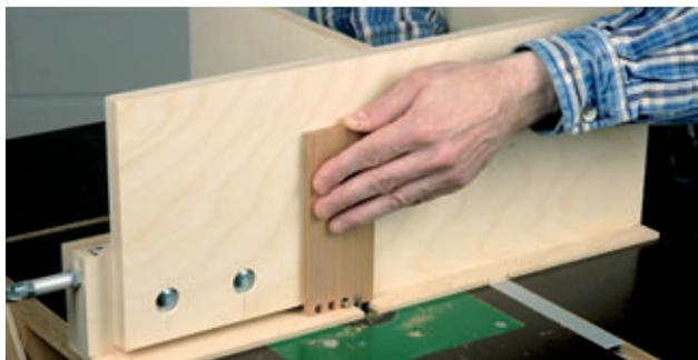
*Passgenaue Fingerzinken zu fräsen kann endlose Einstellarbeit erfordern. Eine selbst gebaute Vorrichtung macht damit ein für alle Mal Schluss.*
