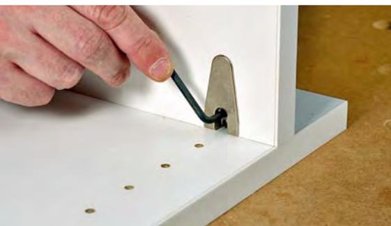
*Möbelbau schnell und erfolgreich: Mit Exzenterverbindern und Topfscharnieren ist das besonders leicht möglich. Und mit der Oberfräse geht es noch schneller.*
