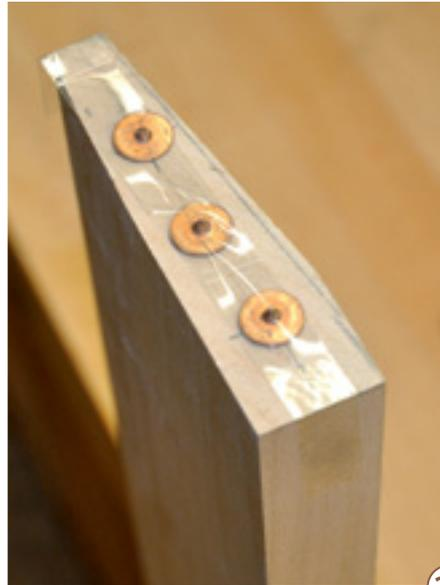
21 > Nach dem Abschrägen die Dübellöcher bohren und Markierstifte einsetzen. Diese können Sie mit Klebestreifen am Herausfallen hindern.
