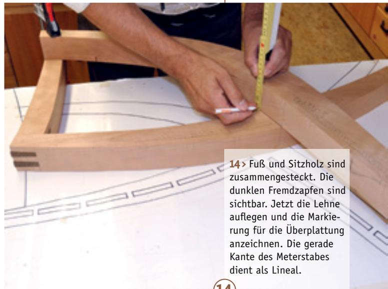
14 > Fuß und Sitzholz sind zusammengesteckt. Die dunklen Fremdzapfen sind sichtbar. Jetzt die Lehne auflegen und die Markierung für die Überplattung anzeichnen. Die gerade Kante des Meterstabes dient als Lineal.
