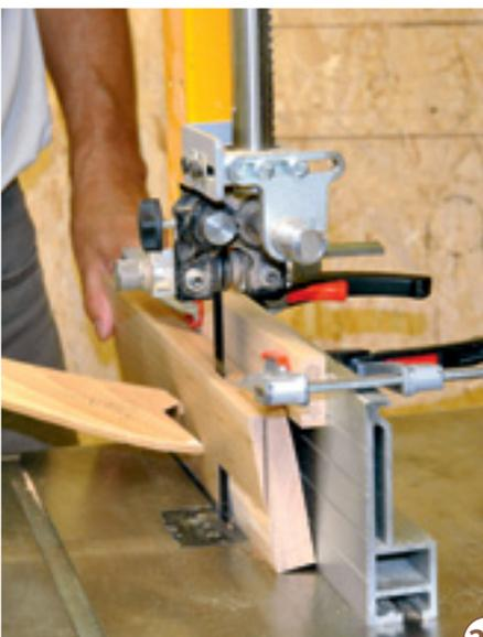
20 > Die Rückseite der oberen Querzarge an der Bandsäge schräg absägen. Eine entsprechend dicke Hilfsleiste, am Parallelschlag angeklebmt, ergibt die richtige Schräge. Diese wird zuvor am Sessel ermittelt.
