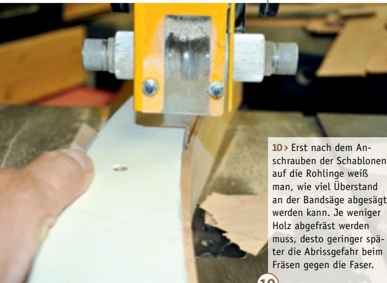
10 > Erst nach dem Anschrauben der Schablonen auf die Rohlinge weiß man, wie viel Überstand an der Bandsäge abgesägt werden kann. Je weniger Holz abgefräst werden muss, desto geringer später die Abrissgefahr beim Fräsen gegen die Faser.
