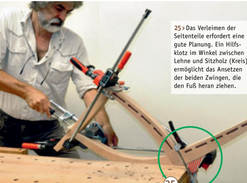
25 > Das Verleimen der Seitenteile erfordert eine gute Planung. Ein Hilfsklotz im Winkel zwischen Lehne und Sitzholz (Kreis) ermöglicht das Ansetzen der beiden Zwingen, die den Fuß heran ziehen.
