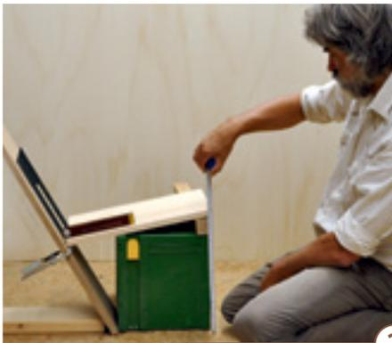
2 > Das Modell ermöglicht eine realistische Ermittlung der Maße und Winkel für den Sessel: Sitzhöhe, Sitz- und Lehnenneigung, Länge der Lehne und Sitzfläche. Die Position der Armlehne wird später am Original ermittelt.
