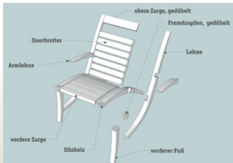
schlusszarge. Letztere wird nach grobem Vorsägen mit der Bandsäge und nach dem Verleimen mit dem Hobel der Form der Lehne angepasst. Weitere Verstrebungen sind aufgrund der ausreichend bemessenen Holzbreite im Bereich der Überplattungen nicht erforderlich, der Sessel ist absolut stabil und verwindungssteif. Am Ende werden noch zwei 50 Millimeter dicke Sitzpolster lose aufgelegt.
