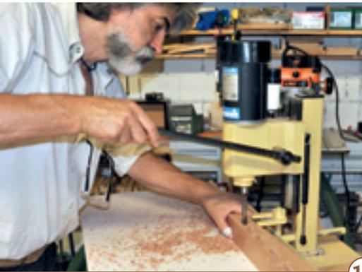
18 > Eine Schlitzstemmmaschine formt die Schlitz für die Querbretter sehr schnell. Alternativ mit einer stationären Bohrmaschine jeweils mehrere Löcher nebeneinander bohren und mit dem Stemmeisen weiter bearbeiten.
