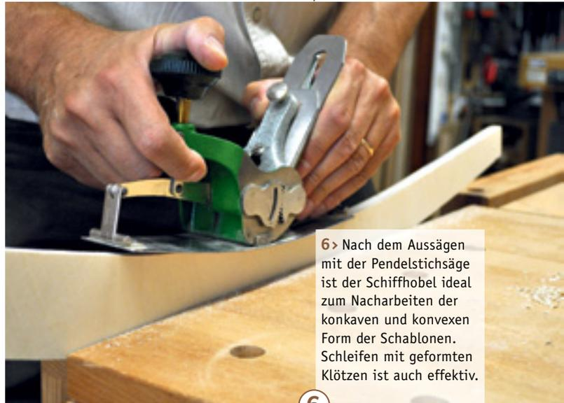
6 > Nach dem Aussägen mit der Pendelstichsäge ist der Schiffhobel ideal zum Nacharbeiten der konkaven und konvexen Form der Schablonen. Schleifen mit geformten Klötzen ist auch effektiv.
