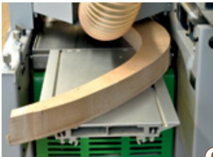
9 > Die Breite des Dickenhobels ist vor allem beim Dickenhobeln wichtig, sonst würde sich das Werkstück beim Durchlassen verkanten. Für die Hobelarbeiten kann der Gang in eine Tischlerei sinnvoll sein.
