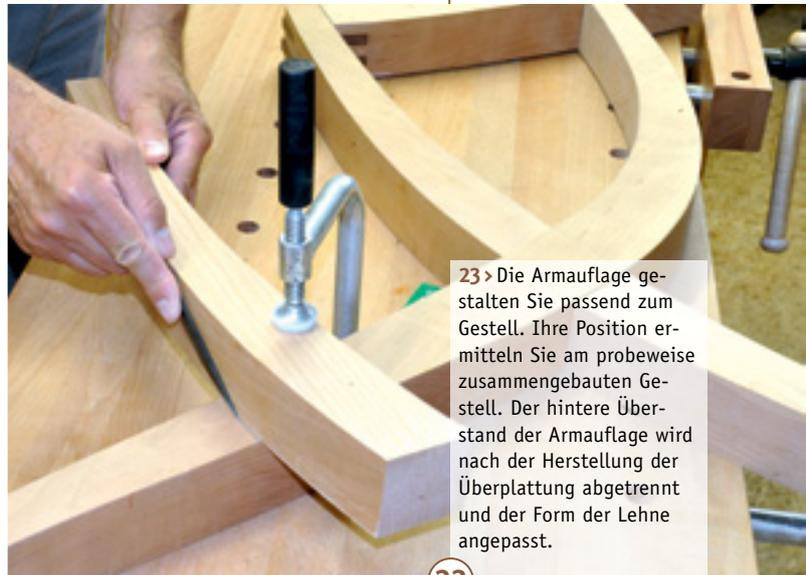
23 > Die Armauflage gestalten Sie passend zum Gestell. Ihre Position ermitteln Sie am probeweise zusammengebauten Gestell. Der hintere Überstand der Armauflage wird nach der Herstellung der Überplattung abgetrennt und der Form der Lehne angepasst.
