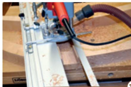
15 > Für die Überplattungen zuerst mit Oberfräse und Führungsschiene das Größte wegfräsen, anschließend mit Stem- oder Bildhauereisen exakt die (geschwungenen) Kanten abstechen.
