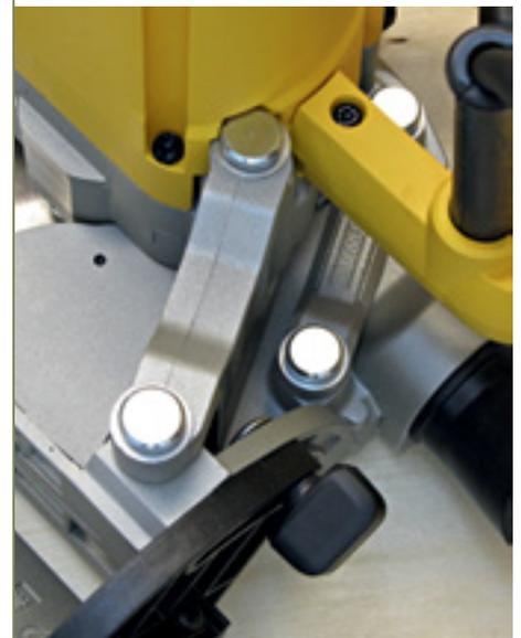
Ungewöhnlich, aber effektiv: Statt auf einen Drehpunkt hinten (wie fast alle Mitbewerber) setzt DeWalt bei seiner Tauchsäge auf eine Parallelogramm-Konstruktion.
