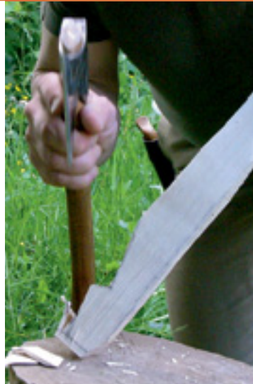
Daraufhin wird der Kopf über dem Haken angeschärft. Dies ist wichtig, damit die Nase des Hakens nicht beim Einschlagen des Hering's abschert.
