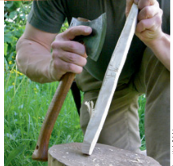
Zum Abschluss werden alle Kanten noch gefast und der Hering kann zelten gehen. In wenigen Minuten fertig und alles mit nur einem Werkzeug gemacht!
