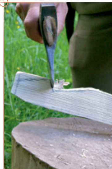
Das roh gesplante Hartholz wird zu nächst mit kräftigen Schlägen in die konisch-rechtwinklige Grundform gebracht. Zum exakten Einkerbigen des Leinenhakens wird der Absatzschnitt verwendet: Das Werkstück wird zusammen mit der am Riss angesetzten Beilklinge auf den Hauklotz geschlagen.
