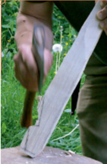
Dann wird mit kurz gefasstem Beil die lange Kerbenseite zugehauen. Übrigens: Die britische Armee nutzt bis heute allein Zeltheringe aus Eschenholz!
