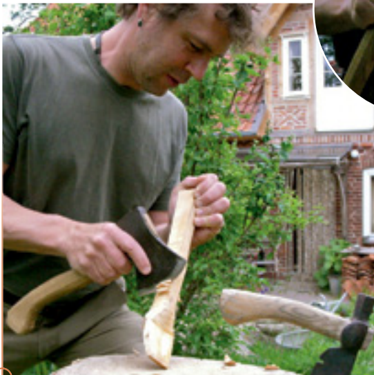
Rein in die Form – Für komplexere Formen wie diesen Kochlöffel geht der Griff auf jeden Fall zum zweiballigen Beil.
