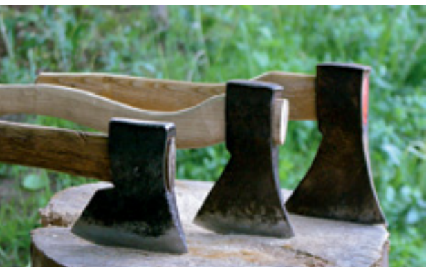
Ein gutes Schnitzbeil hat, wie das alte Stellmacherbeil im Vordergrund, eine lange Klinge, die sehr nahe am Stiel sitzt. Das hinterste Beil ist schlecht zu handhaben, weil die Beilhand nicht nah an der Klinge zupacken kann. So etwas kann, wie beim Beil in der Mitte, durch einen sehr s-förmigen Stiel ausgeglichen werden.
