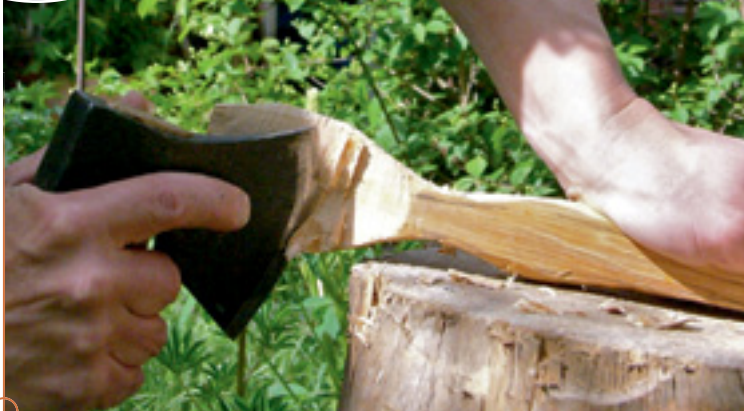
Wenn Werkstück und Faserverlauf vorgeben, dass vom Ende des Werkstücks geschnitten werden muss, wird das Werkstück liegend gehalten und vor dem Hauklotz bearbeitet. Das Beil wird dabei im Präzisionsgriff geführt zur Verlängerung der Hand. Die Löffel-Form wird, bis auf die Höhlung, komplett mit dem Beil angelegt (kleines Bild). Das spart viel Zeit!
