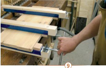
9> Mit einer Stecknuss (Weite 17) kann ganz bequem richtig viel Druck für eine ordentliche Verleimung vorgenommen werden. Auf diese Weise kann sehr sicher, gleichmäßig und kraftvoll gespannt werden.
