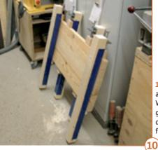
10 > Während der Leim abbindet, kann die ganze Vorrichtung beiseite gestellt werden, und die Hobelbank ist frei für weitere Arbeiten.
