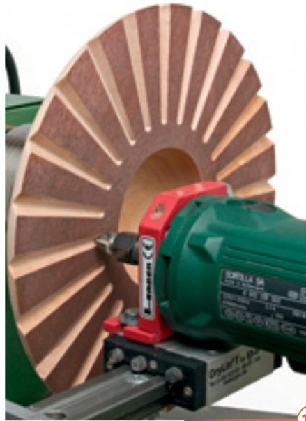
16 > Durch die leicht schräge Ausrichtung des Frässchlittens entstehen hier 24 spitz auslaufende Zierfräsungen, die mit den verstellbaren Anschlägen auf der Führungsschiene präzise begrenzt werden.
