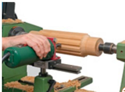
18 > Hier ist der Frässchlitten im Einsatz am Langholz: Das fertig gedrechselte Werkstück wird mit zwölf Hohlkehlnuten verziert. Bei einer 24-Schritt-Teilung muss die Spindel bei jedem 2. Schritt mit der Teilscheibe arretiert werden.
