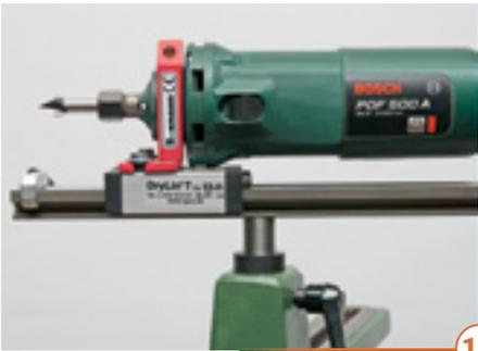
14 > Vor allem aber kommen auf dem Schlitten solche kleinen Fräsaggregate zum Einsatz, die die für das Fräsen notwendige hohe Drehzahl leisten.
