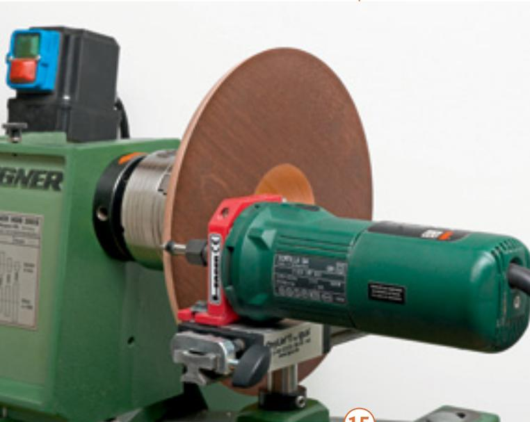
15 > Hier ist der Frässchlitten zur Verzierung eines breiten, gebeizten Schalenrandes mit der kleinen Oberfräse bestückt und in Position gebracht.
