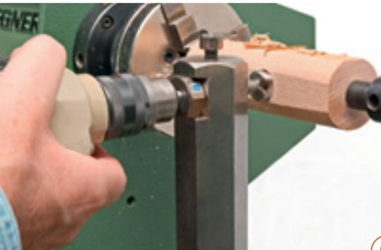
6 > Hier ein Beispiel, wie eine 14-mm-Bohrung mit einem Kunstbohrer eingebracht wird. Dabei ist die Spindel durch die integrierte Teilscheibe spielfrei arretiert.
