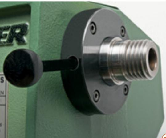
22 > Für die folgenden Arbeiten wird das Werkstück nur an einer Position arretiert. Trotzdem sollte auch hier die Teileinrichtung eingesetzt werden – und nicht die normale Spindel-arretierung der Drechselbank: Diese hat viel mehr Spiel, weil Sie nur über einen Rundstab funktioniert!
