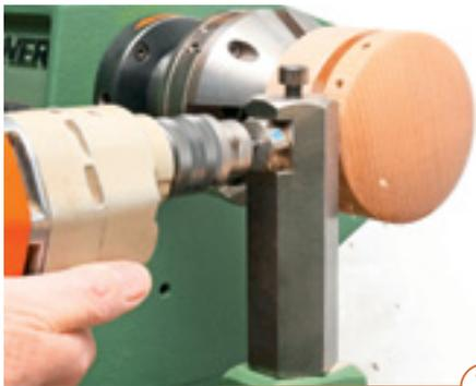
7 > Das zwölfteilige Flügelrad einer Weihnachtspyramide entsteht so: Teileinrichtung arretieren, bohren, Arretierung lösen, Spindel um 30° (zwei Teilschritte à 15°) drehen, arretieren, bohren ... und das, bis alle zwölf Löcher fertig sind.
