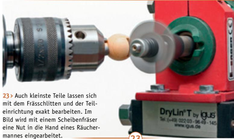
23 > Auch kleinste Teile lassen sich mit dem Frässchlitten und der Teileinrichtung exakt bearbeiten. Im Bild wird mit einem Scheibenfräser eine Nut in die Hand eines Räucherhermannes eingearbeitet.
