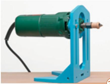
20 > Mit höhenverstellbaren Fräsvorrichtungen lassen sich Zier-Fräsen an konkaven und konvexen Werkstücken wie etwa Schalen ausführen. Die Vorrichtung wird auf einer am Drehbankbett montierten Platte von Hand geführt.
