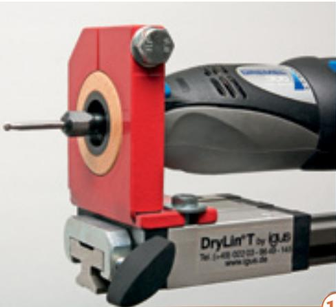
13 > ... ebenso, mit Hilfe eines selbst gefertigten Adapters (der helle Buchenring) kleine Multifunktionsaggregate (Dremel und ähnliche).
