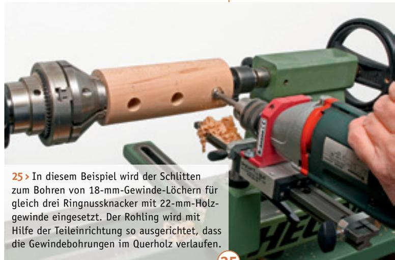
25 > In diesem Beispiel wird der Schlitten zum Bohren von 18-mm-Gewinde-Löchern für gleich drei Ringnussknacker mit 22-mm-Holzgewinde eingesetzt. Der Rohling wird mit Hilfe der Teileinrichtung so ausgerichtet, dass die Gewindebohrungen im Querholz verlaufen.
