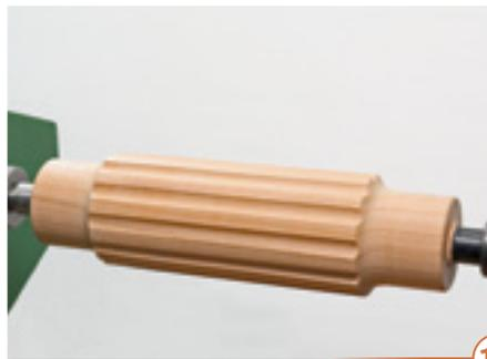
19 > Für solche Fräsarbeiten wird der Einsatz nur durch die Länge der Führungsschiene von 300 mm begrenzt. Es sind aber auch Ausführungen mit 500-mm-Schienen im Handel.
