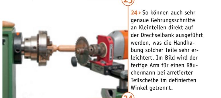
24 > So können auch sehr genaue Gehrungsschnitte an Kleinteilen direkt auf der Drehselbank ausgeführt werden, was die Handhabung solcher Teile sehr erleichtert. Im Bild wird der fertige Arm für einen Räucherhermann bei arretierter Teilscheibe im definierten Winkel getrennt.
