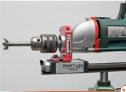
12 > Ein solcher Frässchlitten in Kombination mit der Teileinrichtung erweitert Ihre Möglichkeiten drastisch! Auch er sitzt im Handauflagenunterteil. Der 43-mm-Eurospannhals nimmt natürlich auch Bohrmaschinen auf, ...
