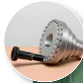
**1** Eine fünfstufige Riemenscheibe mit 24 Teilbohrungen und Federbolzen, wie sie in heutigen Drechselbänken oft eingebaut sind. Bei einer elektronischen Drehzahlregelung ist die Riemenscheibe meist nur dreistufig.
