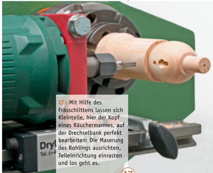
17 > Mit Hilfe des Frässchlittens lassen sich Kleinteile, hier der Kopf eines Räucherannes, auf der Drechselbank perfekt bearbeiten: Die Maserung des Rohlings ausrichten, Teileinrichtung einrasten und los geht es.
