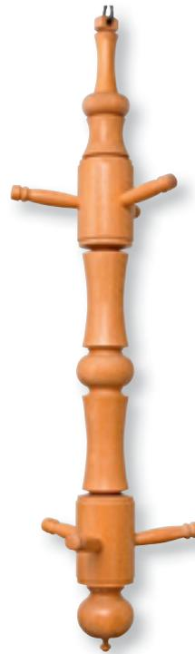
9 > Die je drei Querstege dieser frei hängenden Garderobe wurden mit einer 24-Schritt-Teilung um 120° versetzt (entsprechend 8 Teilschritte) mit Hilfe der Bohrlehre eingebohrt. Um die Stege leicht nach oben zu richten, wurde die Bohrlehre entsprechend schräg zum Werkstück ausgerichtet.
