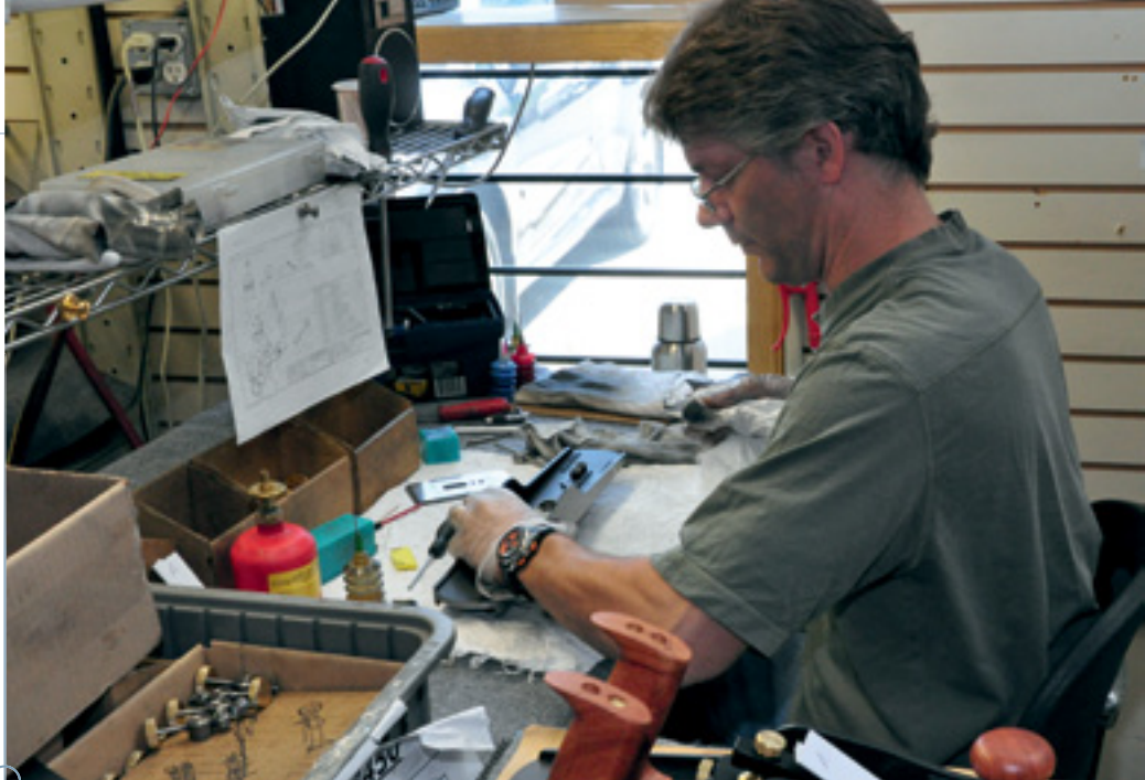
Kanadische Wertarbeit: Viele der rund 120 Mitarbeiter sitzen in Nischen und montieren Teil für Teil von Hand. Hier bekommt der Falz-Hobel seinen Verstell-Mechanismus.
