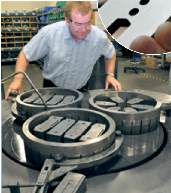
Produktionsleiter Lester Lamarche kontrolliert die Läpp-Maschine für Hobeisen. In den drei Ringen liegen je vier bis sechs Eisen in unten offenen Schablonen. Unterhalb der Ringe dreht sich eine riesige Guss-Scheibe. Gemeinsam mit aufgesprühtem Schleifmittel läppt sie die Spiegelseiten der Hobeisen auf ganzer Länge plan. Auch die neuen Pulvermetall-Eisen werden im Werk in Ottawa so bearbeitet.
