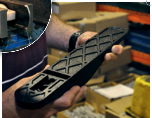
Der gegossene Rohling des neuen Falz-Hobels hat noch eine stabilisierende Rippenstruktur unter der Sohle. Sie wird per Fräse entfernt und dann folgen 140 weitere Dreh-, Bohr- und Fräsvorgänge im modernen Veritas-Maschinenpark.
