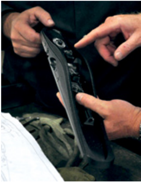
Prüfen, vergleichen, messen und auch diskutieren: Die Qualitätskontrolle an sieben Stationen nimmt pro Hobelexemplar rund zwei Stunden in Anspruch.
