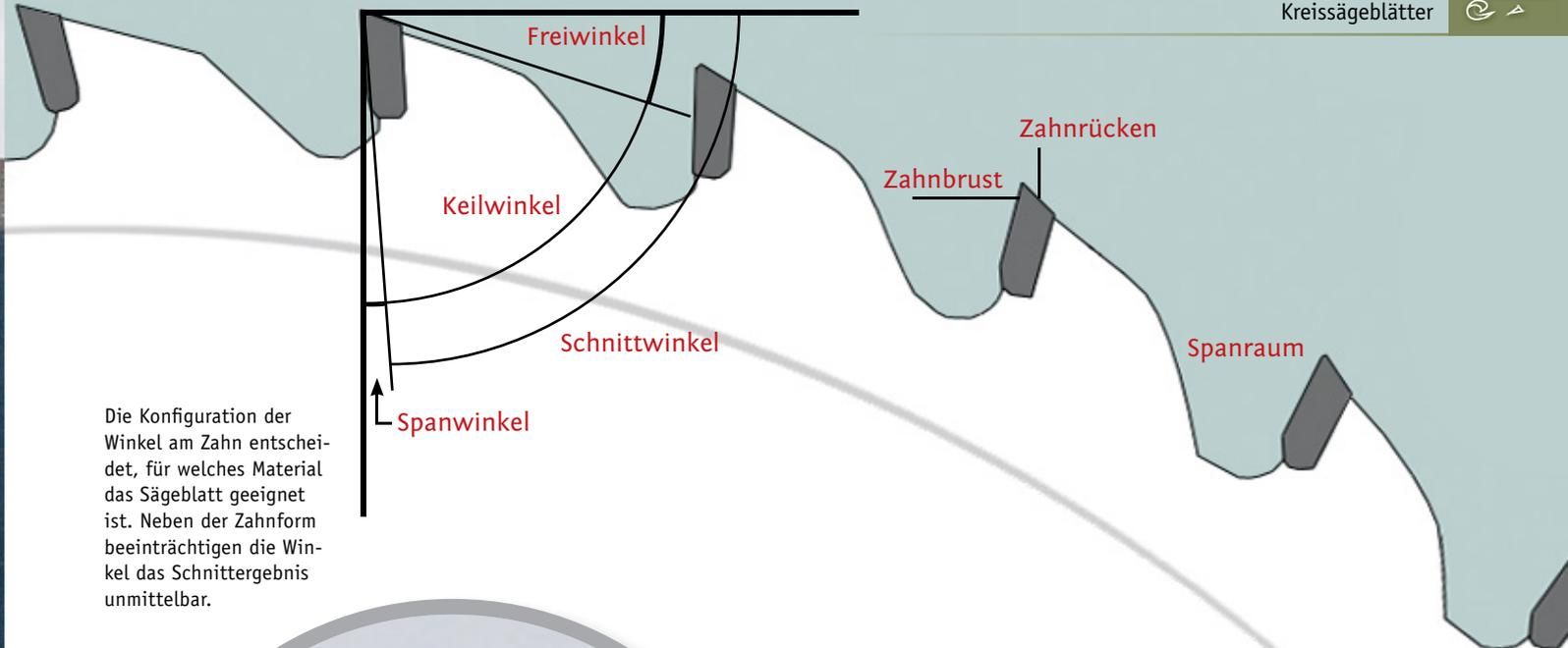
Die Konfiguration der Winkel am Zahn entscheidet, für welches Material das Sägeblatt geeignet ist. Neben der Zahnform beeinträchtigen die Winkel das Schnittergebnis unmittelbar.
