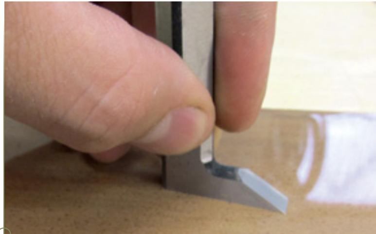
Danach nur noch fein die Spiegelseite abziehen. Schärfe ist beim Grundhobel noch bedeutender als bei anderen Hobeln.
