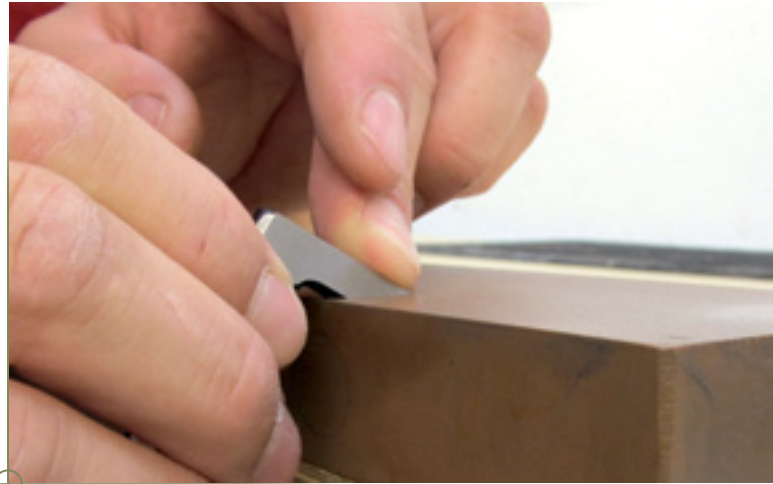
Die Fase des Eisens wird geschliffen, während der Rest des Eisens neben dem Stein nach unten weist.
