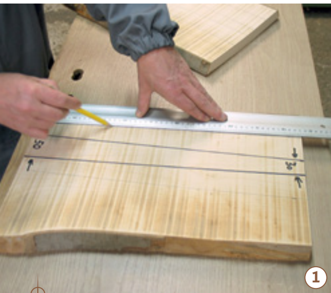
1 Beginnen Sie mit der Holz Auswahl: Ein Buchenbrett mit einer gleichmäßig feinen und geradfaserigen Struktur möglichst ohne Störungen bringt das beste Ergebnis.
