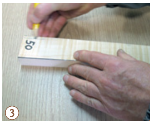
3 Um die Sägespuren später nicht aufwendig durch Schleifen beseitigen zu müssen, sollten Sie jetzt die Längsseiten des Grundkörpers durch Hobeln oder Schleifen glätten. Von der breiten Seite (fünf Zentimeter) des Trapezes aus zeichnen Sie dann die etwa fünf Millimeter starken Greifarme der Grillzange auf den Grundkörper.
