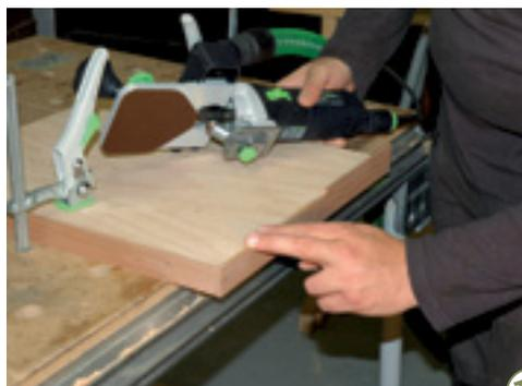
13 > Wichtig ist eine fein justierbare Einstellmechanik. Der Fräser sollte exakt mit der Kantenstärke fluchten, damit das Plattenmaterial keine Schäden nimmt.
