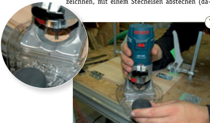
7 > Für die Sichtfräsung ist ein genauer und deutlicher Anriss notwendig. Die Frästiefeneinstellung erfolgt in Scharnierstärke. Durch das geringe Zerspannvolumen lässt sich die Fräse relativ einfach führen. Wichtige Voraussetzung: das Werkstück muss fest gespannt sein!
