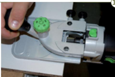
10 > Der Fräser wird mit der Höhenverstellung, der Führungsplatte und der Distanzverstellung der Fräse sehr genau führbar. Zur besseren Darstellung wurde die Absaughaube entfernt.
