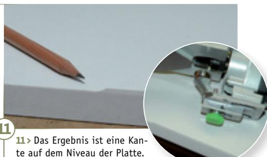
11 > Das Ergebnis ist eine Kante auf dem Niveau der Platte. Bei stärkeren Kanten sollte noch mit einem Radius oder einer Fase gearbeitet werden. Bei den schmalen Bügelkanten empfiehlt sich ein Abschluss mit einem weichen Schleifklotz und feinem Schleifpapier.
