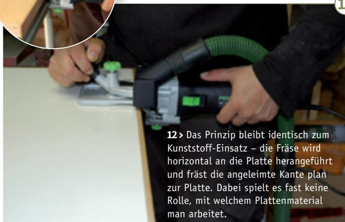
12 > Das Prinzip bleibt identisch zum Kunststoff-Einsatz – die Fräse wird horizontal an die Platte herangeführt und fräst die angeleimte Kante plan zur Platte. Dabei spielt es fast keine Rolle, mit welchem Plattenmaterial man arbeitet.
