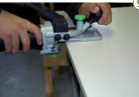
9 > Mit Schmelzkleber ausgestattete Kanten lassen sich gut und einfach verarbeiten. Damit Platte und Kante aussehen wie aus einem Guss, muss beides plan zusammenpassen und die sichtbare Außenkante bearbeitet sein.
