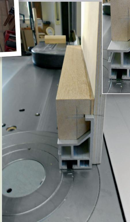
7> Für die Felder-Säge muss ein eigenes Halteholz konstruiert werden, das auf das 45°-Anschlagprofil der Säge passt. Bei anderen Fabrikaten wird es einfacher sein, die Vorrichtung an den Parallelanschlag anzupassen.
