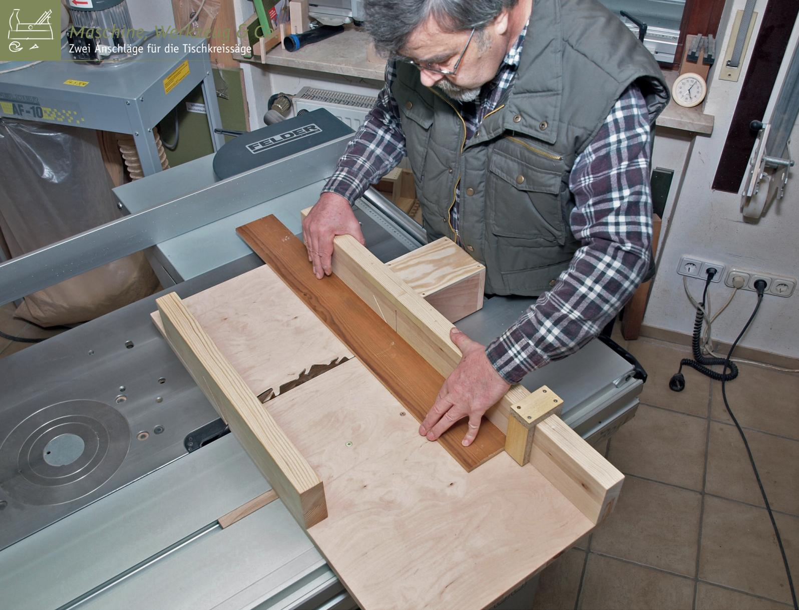
Die Tischkreissäge ist ein vielseitiges Instrument – wenn man die richtigen Anschläge einsetzt. Winkelschnitte, wiederholgenaues Ablängen sowie Schlitz- und Zapfenverbindungen sind dann auch an kleinen Sägen kein Problem. Unser Autor Werner Hemmeter stellt zwei seiner selbstgebauten Anschläge vor.
