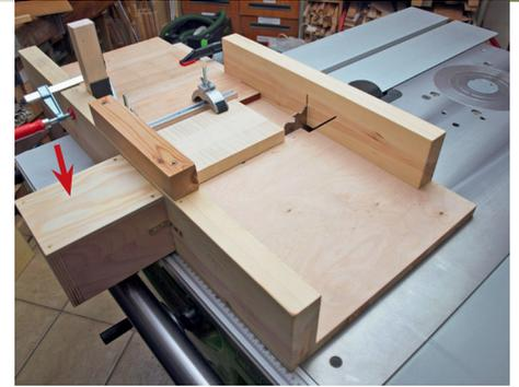
1 > Ein wichtiger Punkt in Sachen Sicherheit: Die Schutzhaube (Pfeil). Wird der Anschlag auf der Säge nach vorne geschoben, fährt das Sägeblatt in diesen Kasten und wird vollständig verdeckt.
