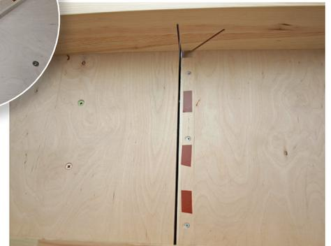
2 > Ein wenig umrüsten muss man die Säge zwischen 90°- und 45°-Schnitten. Wird das Sägeblatt gekippt, muss die Leiste, die beim ersten Schnitt angefallen ist, entfernt werden. Beim 90°-Schnitt muss sie montiert sein; sonst können Reststücke festkleben.
