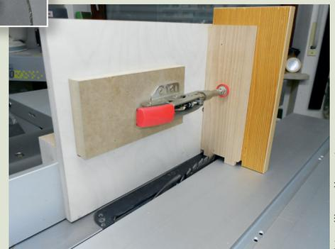
8> Sollen Fingerzinken, Falze oder Nuten hergestellt werden, muss die Vorrichtung umgerüstet werden oder neu gebaut werden, wenn beides gleich oft hergestellt wird. Das Anlegeholz wird im 90°-Winkel zum Hauptbrett von hinten durchgeschraubt.
