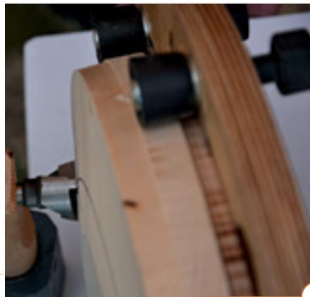
**6** Hier der Blick von oben. Weil die Schräge bereits angelegt ist, kann nun rechtwinklig in diese hineingebohrt werden. Das macht das Ansetzen der Bohrung viel leichter und schließt das nervige seitliche Abrutschen aus.
