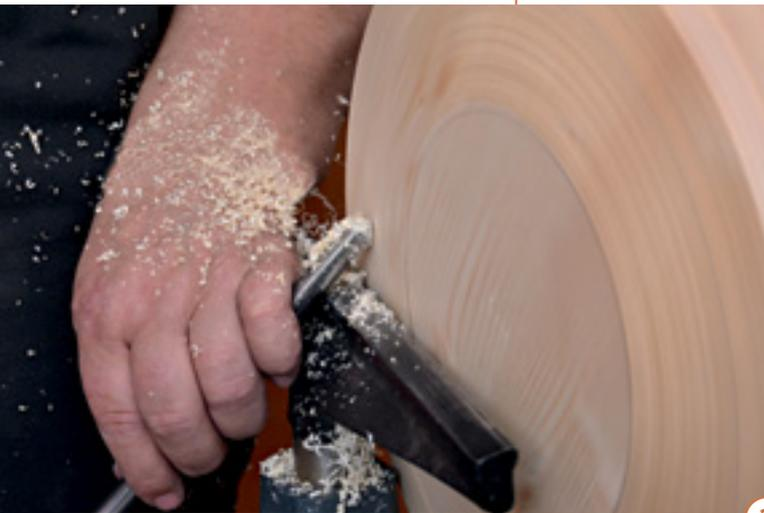
**2** Nach dem Plandrechseln wird der äußere Bereich der Unterseite schräg angelegt. Das wirkt leichter und die Bohrung kann später im rechten Winkel zur Schräge angesetzt werden. Zeichnen Sie so an: Die 8:1-Schräge wird an der Kante einen Zentimeter hoch und ragt acht Zentimeter in die Fläche. Das ergibt eine Schräge von etwa 7,5°. Entfernen Sie den Überschuss und drechseln Sie die flache Kegelfläche glatt. Die Drehzahl liegt bei nur etwa 450 U/min.
