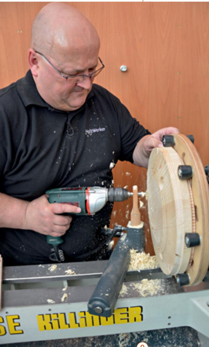
9 > Steuern Sie dann die zwei weiteren Bohrpunkt an. Diese legen Sie entweder per Anriss fest oder finden sie mit der Teileinrichtung Ihrer Drechselbank.
