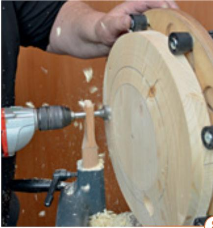
8 > Bei ausgeschalteter Maschine und arretierter Spindel können Sie nun den ersten Bohrpunkt setzen. Wenn es durchgehende Bohrungen sein sollen, muss das Futter durch eine zwischengelegte Platte geschützt sein. Hier allerdings entstehen Sacklöcher mit 30 mm Tiefe.
