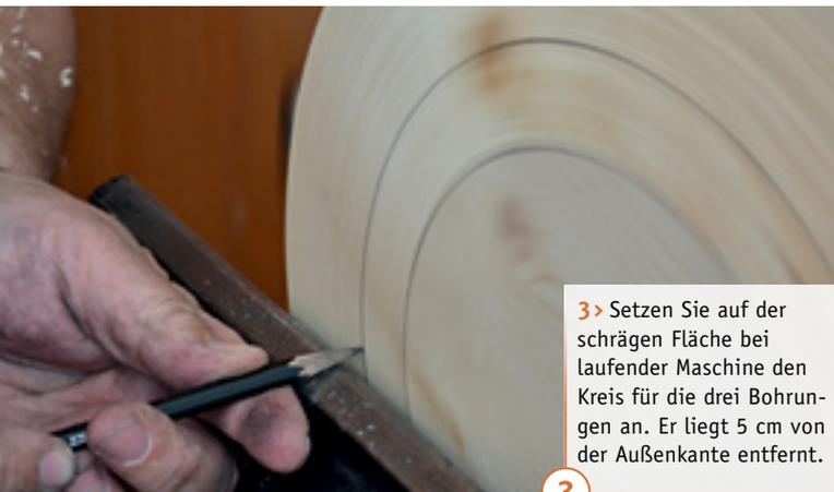
**3** Setzen Sie auf der schrägen Fläche bei laufender Maschine den Kreis für die drei Bohrungen an. Er liegt 5 cm von der Außenkante entfernt.
