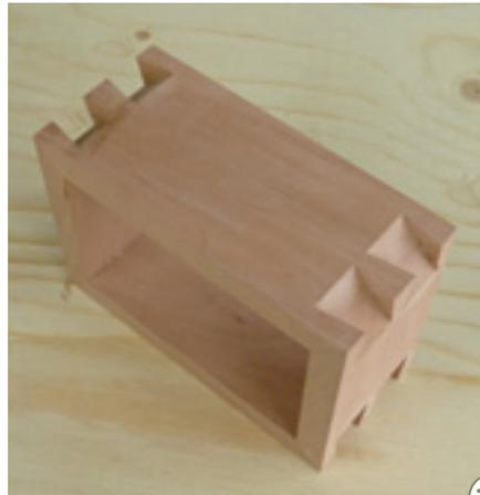
17 > Der Gratfräser darf nicht zu tief eingestellt werden. Ein wenig Holz muss noch in der Ecke stehen bleiben, sonst könnte sich die stumpfe Verleimung beim Fräsen lösen. Achten Sie darauf, dass Sie nicht versehentlich in eine Schraube in der Vorrichtung fräsen.
