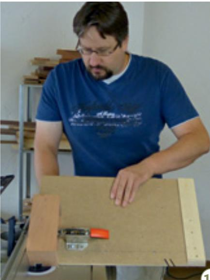
15 > Wie die falschen Federn können auch falsche Zinken eine stumpf auf Gehrung verleimte Ecke stabilisieren. Bei dieser Anwendung wird die 45°-Rampe auf dem Frästisch eingesetzt. Mit einem normalen Nutfräser können Sie Fingerzinken imitieren. Mit einem Gratfräser entstehen wie hier falsche schwalbenschwanzförmige Zinken.
