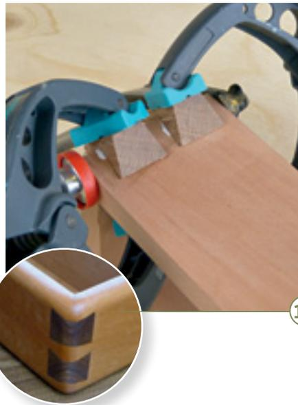
18 > Die falschen Zinken werden auf der Tischkreissäge passgenau geschnitten und in die Fräsungen geleimt. Auch hier kann Holzkontrast die Eckverbindung hervorheben. Nach dem bündigen Abschneiden der Überstände haben Sie eine stabile und dekorative Eckverbindung.
