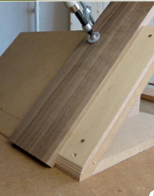
5 > Das Werkstück – ein Streifen Nussbaum – wird zunächst auf einer ebenen Unterlage auf die Rampe aufgespannt. So können auf null auslaufende Gehungen geschnitten werden, ohne dass sich das Werkstück im Sägeblattschlitz verkeilen kann. Der aufgeschraubte Sperrholzstreifen verhindert, dass sich das Werkstück verdreht.
