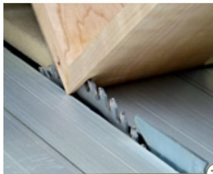
11 > Achten Sie auf die richtige Höheneinstellung des Sägeblattes, um nicht ins Kasteninnere zu schneiden. Hier gilt es zu wählen: Für eine Nut mit ebenem Nutgrund wäre ein Flachzahn-Sägeblatt optimal, für einen möglichst aufrissfreien Schnitt hingegen ein Sägeblatt mit Wechselbezahnung.
