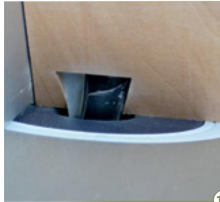
16 > Die Vorgehensweise ist ähnlich wie beim Sägen der falschen Federn. Statt eines Sägeblattes kommt ein Fräser zum Einsatz. Die 45°-Rampe wird am Fräsansschlag entlang geführt. Besonders effektiv sieht diese Verbindung aus, wenn man sie mit einem Gratfräser erstellt.
