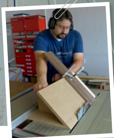
Diese einfache Vorrichtung erlaubt es, Schnitte weit jenseits von 45° auszuführen, falsche Federn einzusetzen oder flache Zinken herzustellen. Die kleine Rampe kann längs und quer zu Sägeblatt oder Fräser geführt werden und erhöht ihre Einsatzbereitschaft noch weiter. Anhand dreier Beispiele zeigen wir Ihnen, was man mit diesem einfach zu bauenden Helfer so alles machen kann. Sicherlich fallen Ihnen aber noch weitere Möglichkeiten ein.
