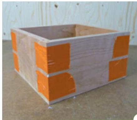
9 > Nächstes Beispiel: Falsche Federn. Stumpf verleimte Gehungen (Bild) sind leider nicht sehr stabil. Eine Möglichkeit der Stabilisierung bilden falsche Federn, die nach dem Verleimen von außen eingesetzt werden. Sind sie aus kontrastreichem Holz, können sie auch als Gestaltungsmittel eingesetzt werden.
