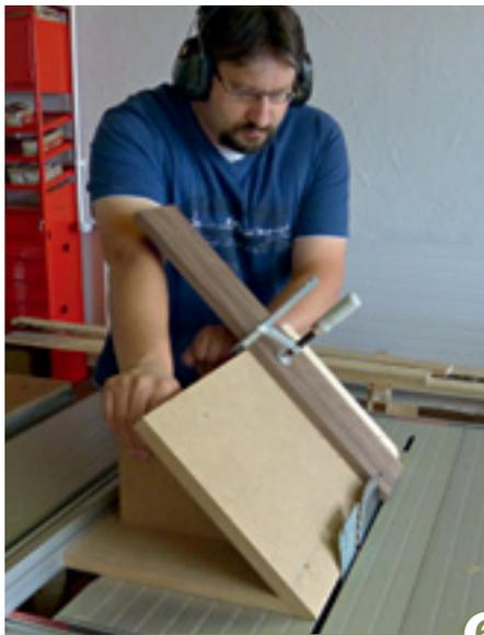
6 > Das Werkstück wird durch die Rampe auf 45° zur Tischebene angehoben. Durch Neigen des Sägeblattes können nun Winkel jenseits von 45° problemlos geschnitten werden. Die Vorrichtung wird samt aufgespanntem Werkstück am Parallelanschlag entlang geführt. Sie selbst können weit außerhalb des Gefahrenbereiches stehen, die Hände sind weit vom Sägeblatt entfernt.
