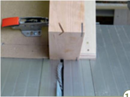
13 > ... oder Sie stellen das Sägeblatt schräg und führen die 45°-Rampe am Parallelanschlag vorbei. Wählen Sie die Variante, die bei Ihrer Tischkreissäge am besten und sichersten funktioniert.
