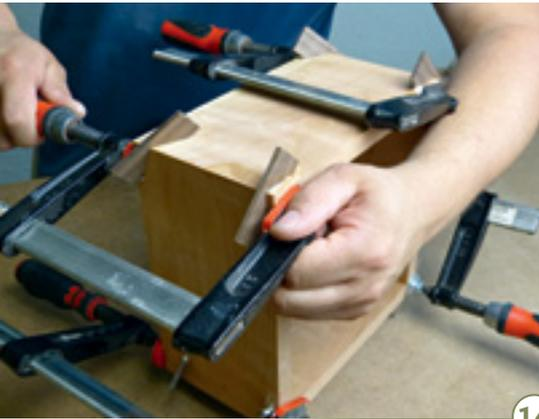
14 > In die gesägten Schlitzte werden nun die losen Federn geleimt. Diese sollten nicht zu straff eingepasst werden, damit der Leim nicht vollständig abgestreift wird, wenn die Feder in den Schlitz gesteckt wird. Einige Schraubzwingen halten alles am Platz, bis der Leim abgebunden ist.
