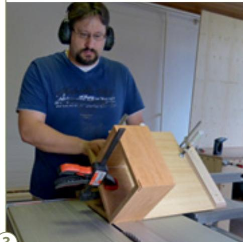
3> Die Vorrichtung kann sowohl an der Tischkreissäge als auch am Frästisch verwendet werden. Hier im Bild wird sie einfach an den Queranschlag der Säge gelegt.
