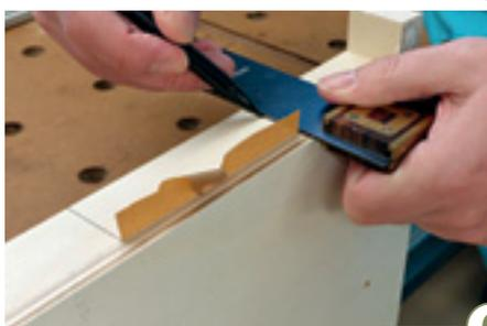
6 > Nach dem Abbinden des Leims können die Zwingen entfernt werden. Übertragen Sie nun mit Hilfe der Kanten der Abklebung die Endpunkte der beiden Diagonalen, an denen die Spannten im nächsten Schritt gekürzt werden.
