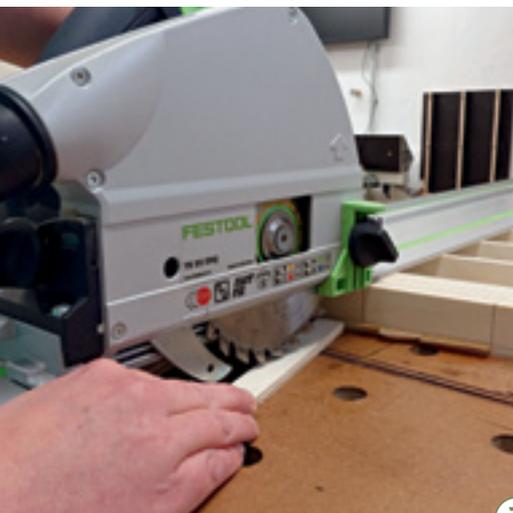
7 > Legen Sie die Führungsschiene der Handkreissäge an die markierten Endpunkte. Stellen Sie die Sägetiefe so ein, dass die Deckplatte keinesfalls eingeschnitten wird. Dies gelingt mit Hilfe eines Reststückes in der Dicke der Deckplatte.
