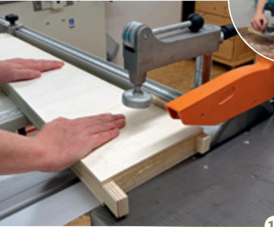
11 > Die überstehenden Enden der Holme können nun abgesägt, die Überstände der Deckplatten bündig gefräst und die beiden Armteile sauber geschliffen werden. Ölen, lackieren oder lasieren Sie die Oberflächen mit dem Mittel Ihrer Wahl.
