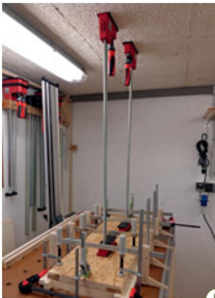
5 > Zuletzt leimen Sie den unteren Holm auf die Deckplatte und an die Stirnseiten der Spannten. Ein dickes Brett als Auflage verteilt den Pressdruck gleichmäßig – „spreizende“ Zwingen, zur Decke hin abgestützt, sind da sehr nützlich. Setzen Sie auch Zwingen quer an, um die Holme an die Spannten zu pressen.
