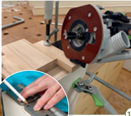
12 > Die massiven Bänder werden am besten eingefräst. Dazu kommt eine einfache, aus Holzresten verleimte Schablone zum Einsatz. Als Fräser dient ein Bündigfräser mit unten sitzendem Anlaufring und einem Durchmesser, der zu den Rundungen der Bandlappen passt.
