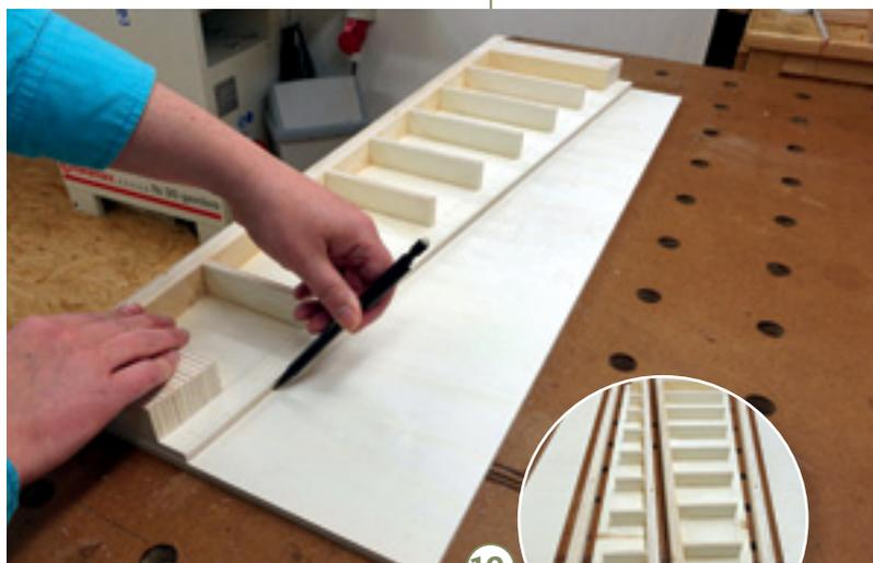
10 > Mit den beiden ersten Teilstücken des Armes als Schablone können Sie nun die fehlenden Deckplatten zuschneiden und dann aufleimen. Setzen Sie wieder genügend Zwingen an und lassen Sie den Leim am besten über Nacht aushärten.
