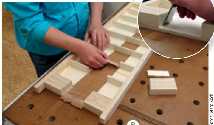
8 > Nach den beiden diagonalen Sägeschnitten kann der mittlere Teil der Spannten nun leicht herausgetrennt werden. Entfernen Sie das Packband und verputzen Sie eventuell stehen gebliebene Fasern mit dem Stecheisen, ohne dabei die Deckplatte zu beschädigen.
