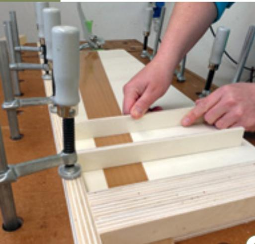
4 > Leimen Sie nun den oberen Holm bewusst etwa einen Millimeter zurückspringend auf die Deckplatte. Fixieren Sie den Holm mit ein paar Zwingen und leimen Sie alle Spannten an den Markierungen auf. Verleimen Sie die dickeren kopfseitigen Spannten auch flächig untereinander.
