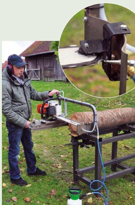
*Holzinschnitt auf die coole Art: Weil die Kette schnell überhitzte, hat sich Schweizer eben eine Kühlung mit Hilfe einer Tragspritze für den Garten entwickelt.*
