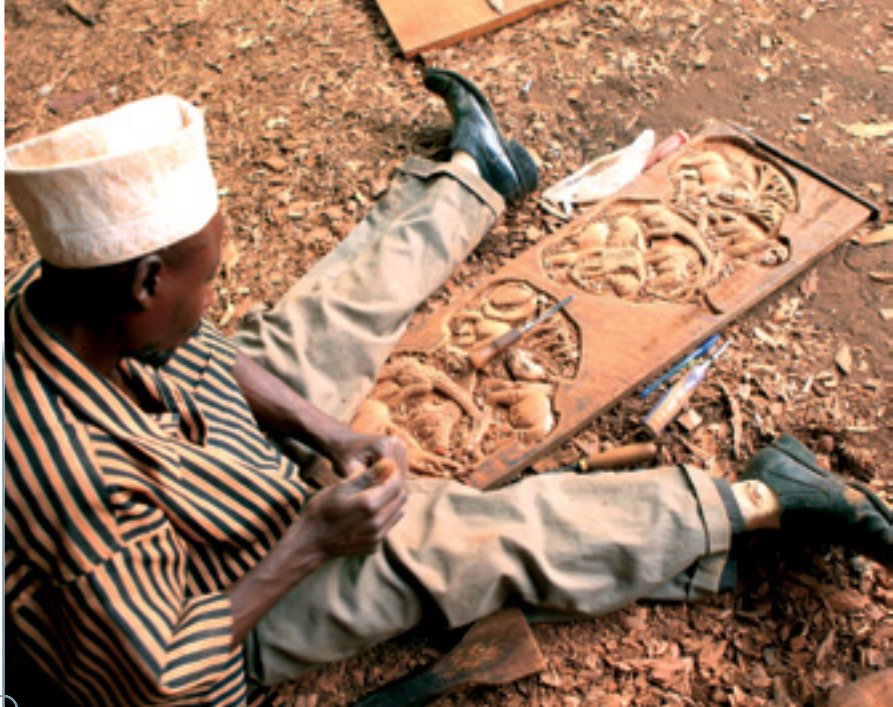
Spannvorrichtungen kommen nicht zum Einsatz: Das Körpergewicht des Schnitzers hält das Werkstück fest.
