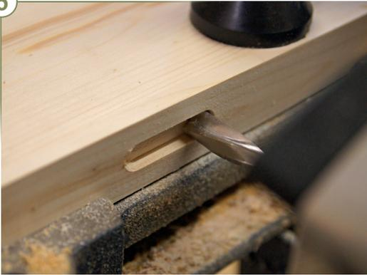
Eine weitere Möglichkeit ist das Fräsen der Langlöcher. An beiden Enden wird auf die gesamte Tiefe gebohrt. Dann wird der Zwischenraum in 3-mm-Schritten ausgefräst. Der Vorschub ist je nach Holzart anzupassen. So ist zum Beispiel bei Eiche langsamer vorzugehen als bei Fichte.
