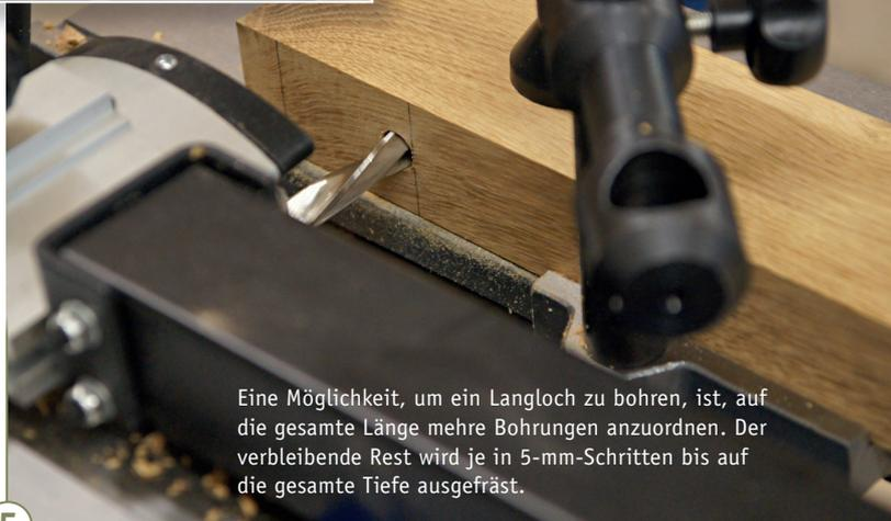
5 Eine Möglichkeit, um ein Langloch zu bohren, ist, auf die gesamte Länge mehrere Bohrungen anzuordnen. Der verbleibende Rest wird je in 5-mm-Schritten bis auf die gesamte Tiefe ausgefräst.
