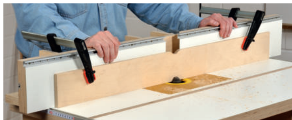
Einfaches Vorsatzbrett aus Multiplex (mind. 12 mm dick)
