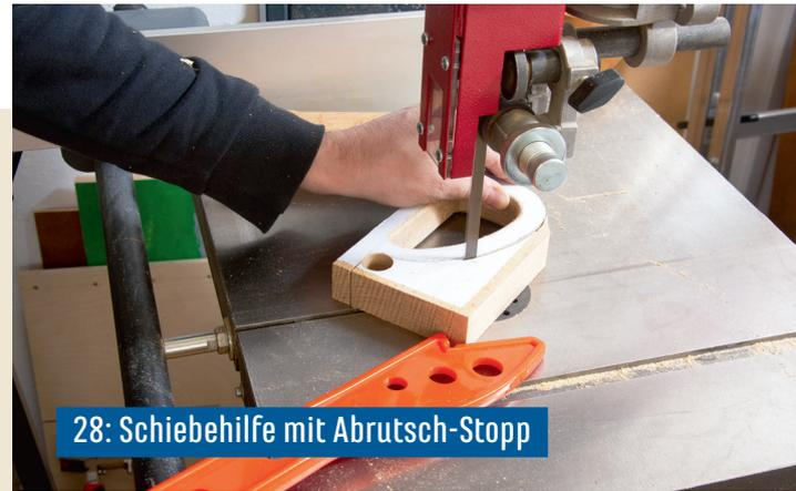
28: Schiebehilfe mit Abrutsch-Stopp
