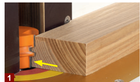
1 Achten Sie darauf, dass vom unteren Bereich (Pfeil) des Werkstücks nichts abgefräst wird, sonst liegt die Kante nicht mehr dicht am Anschlag an.
