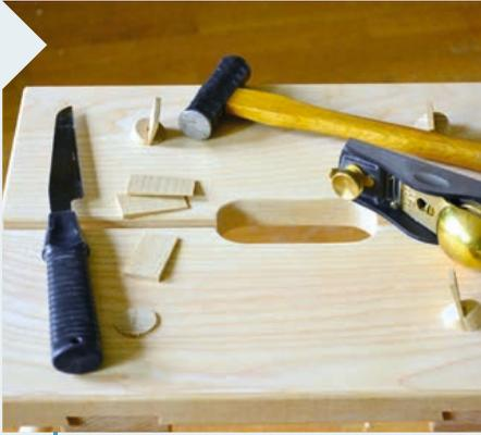
**18** Hier muss kein Leim aushärten, denn es wird einfach keiner verwendet. Sie können direkt mit dem Kürzen der Zapfenstummel beginnen und die Reste mit dem Einhandhobel einebnen. Danach folgt die Feinarbeit auf der Oberfläche, hobelnd oder schleifend.
