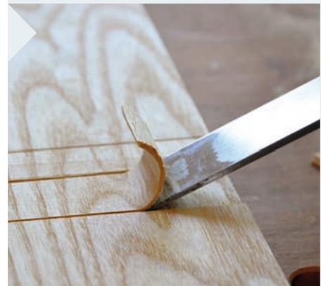
3 Ein zusätzlicher Schnitt mitten in der Nut erleichtert das grobe Ausstemmen. Sie können hier ruhig zügig arbeiten und bis etwa einen Millimeter über der Zieltiefe hinabtauchen. Wenn ein Stich mal zu tief gerät, ist das auch kein Beinbruch.
