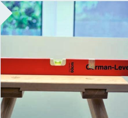
**19** Um den Hocker zu entkippeln, richten Sie ihn mit einer Wasserwaage in beide Richtungen zur Aufstandsfläche aus (diese Fläche muss natürlich auch „im Wasser“ sein). Übrig gebliebene Keile können dabei helfen,...
