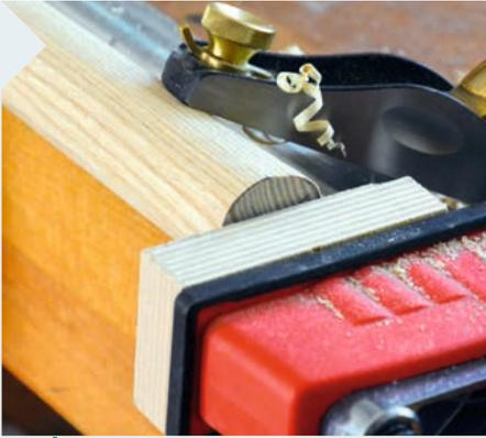
**12** | Arbeiten Sie mit langen Hobelzügen, bis die Kreise auf beiden Seiten erreicht sind. Der Einhandhobel nimmt den immer noch fühlbar verbliebenen Facetten endgültig die Spitzen. Den Rest erledigt Schleifpapier oder noch besser formbares Schleifleinen.
