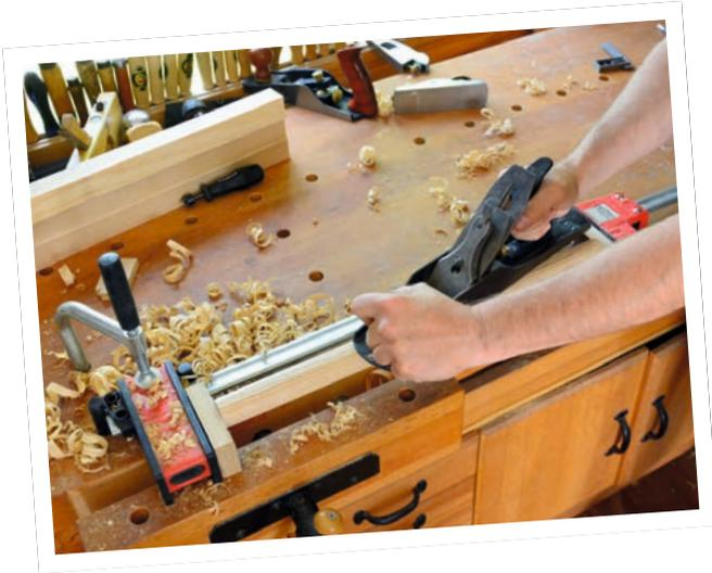
Die Zapfenbereiche der Beine lagen einige Tage in die Sommersonne, damit sie schön trocknen konnten, dann erst wurden sie eingepasst. Wenn so präparierte Holzteile verbaut sind, nehmen sie wieder Wasser auf, quellen und machen die Verbindung fest. Das Gleiche gilt auch für die Keile, die sehr trocken eingeschlagen werden. Wir verlassen uns hier völlig auf die Natur des Holzes: Am ganzen Hocker findet sich kein einziger Tropfen Leim!
