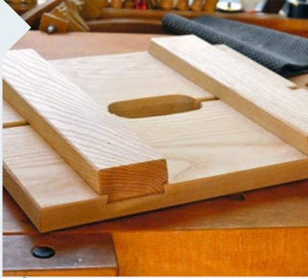
**5** Die leicht abgeschrägten Gratleisten sollten stramm in die Nuten rutschen. Wenden Sie keine harten Schläge an. Wenn es arg zu stramm ist, hobeln Sie eine Flanke der Gratfeder ganz, ganz behutsam nach. Und: Schmierseife hilft dem Holz enorm beim Gleiten.
