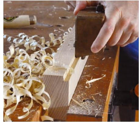
1 Ein Grathobel (hier ein Erbstück) lässt sich auf die Falzbreite einstellen und dann geht es Schritt für Schritt abwärts, bis der Tiefenstopp greift. Wichtig ist, dass der Hobel dabei genau senkrecht geführt wird - am besten vorab etwas üben.
