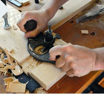
**4** Senken Sie das Eisen des Grundhobel zum Einstellen auf der „höchsten“ Stelle ab, legen Sie ein dickes Papier unter den Körper und arretieren Sie alles. So werden die „Höhepunkte“ abgenommen. Richten Sie sich dann nach der außen angezeichneten Nuttiefe.
