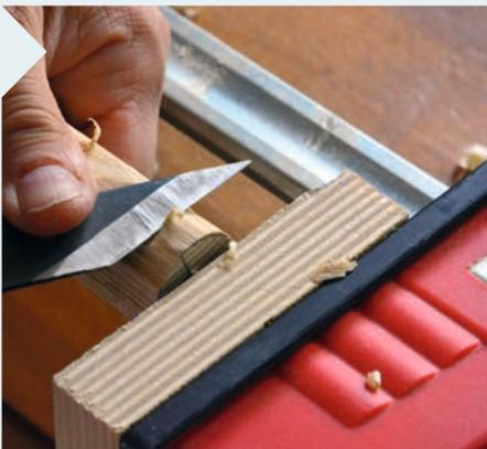
**15** | Den Rest übernimmt, je nach Geschmack, ein Werkstattmesser, ein quer zur Faser eingesetzter Simshobel oder ein Schleifklotz. Die Zapfenherstellung geht von Bein zu Bein schneller. Mindestens eine halbe Stunde müssen Sie fürs Anpassen aber schon rechnen.
