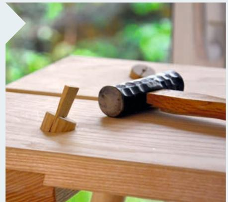
**17** | Diese Keile wurden in der Mikrowelle getrocknet, mit mehreren 600-Watt-Stößen, je 20 Sekunden lang. Bei normaler Luftfeuchtigkeit quellen Sie dann nach dem Einschlagen auf. Richten Sie die Schlitz in den Beinen rechtwinklig zu den Fasern im Sitzbrett aus.
