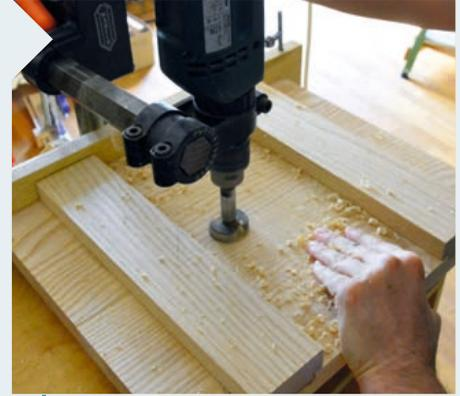
**6** Die beiden Sitzbretter werden für die Herstellung der Griffaussparungen zusammengeschieben und dann dreimal gebohrt: zweimal an den beiden äußeren Positionen und einmal in der Mitte, um möglichst viel Abfall zu entfernen.
