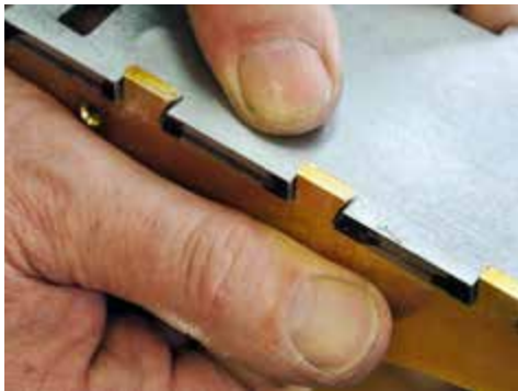
Perfekte Vorbereitung: Wenn Seite und Sohle so genau ineinander gleiten, können sie für immer verbunden werden.
