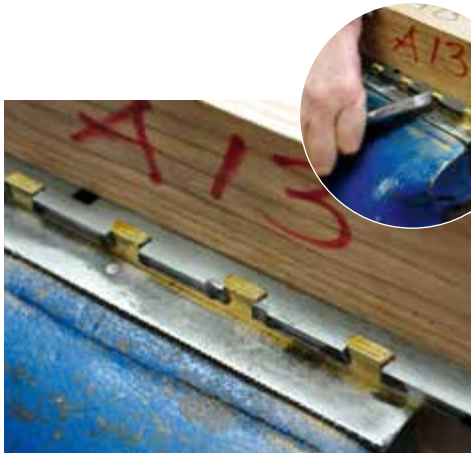
Mit verschiedenen Meißeln treibt Fritsche den Sohlenstahl so, dass er die Schwalben der Seiten umschließt: So entsteht eine unlösbare Verbindung.
