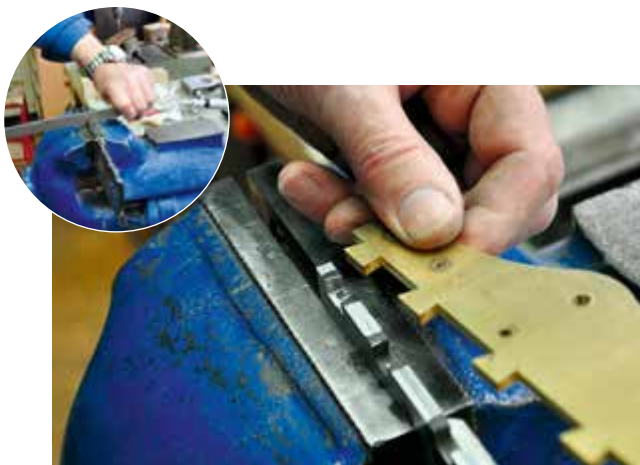
Die Schwalbenschwänze der Seite (hier aus Messing) werden schräg gefeilt, um Platz für die Zinken zu schaffen.
