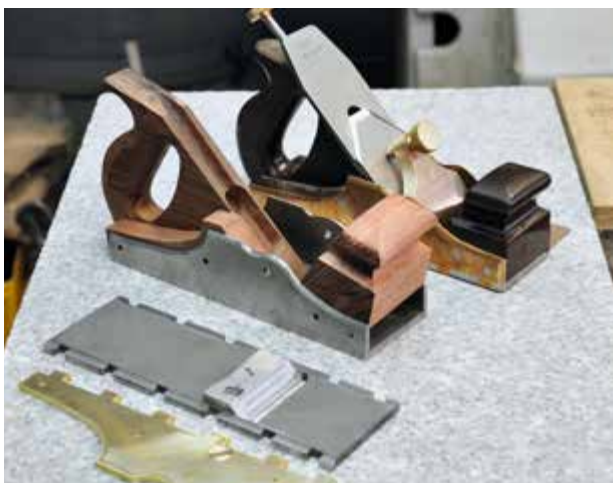
Drei Entwicklungsstadien: Einzelteile vorn, fertiger Korpus mit einzelnen Holzteilen in der Mitte, fertiger A13 hinten.
