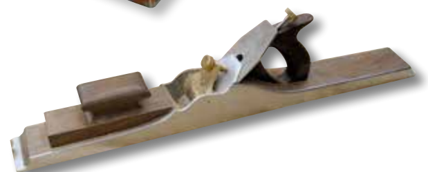
Raubank A1, 71,2 Zentimeter lang, 63,5 mm Eisenbreite, mit afrikanischem Rosenholz: 6,5 Kilogramm Schwungmasse!
