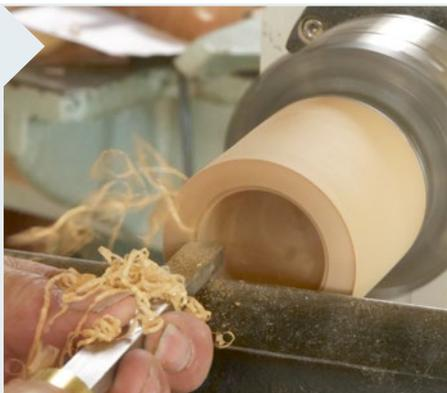
**15** | Nun zur Dose! Höhlen Sie sie grob mit der Röhre auf einem Durchmesser von 45 mm aus. Dann kann der Schaber (hier ein spezielles Döscheneisen) den kleinen Falz anlegen: Tasten Sie sich vor und testen Sie oft, ob sich der Deckel schon einlegen lässt.
