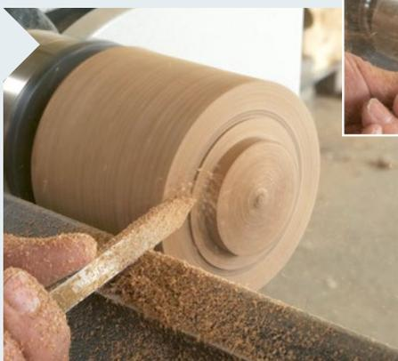
**2** Drechseln Sie aus einem harten, dichten Reststück von mindestens 85 mm Durchmesser ein Hilfsfutter. Es bekommt einem 50-mm-Zapfen, der sowohl in Ihr Spannfutter passt als auch in das eben gebohrte Hilfsbrett. Stechen Sie die Scheibe auf 15 mm Dicke ab.
