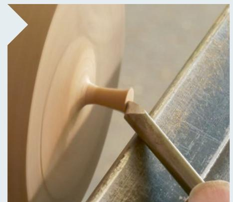
**14** Hier ist der Griff 15 mm hoch und misst an seiner dünnsten Stelle 5 mm. Der oberste Bereich bekommt noch eine die Finger einladende kleine Vertiefung. Wenn alles passt, schleifen Sie Deckel samt Griff fertig und bringen Oberflächenmittel auf.
