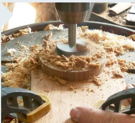
**4** Spannen Sie alles so unter den erneut eingespannten 50-mm-Bohrer, dass er 10 mm außermittig in die runde Futterzscheibe arbeitet. Bohren Sie 6 mm tief. Dies wird die Aufnahme für den exzentrisch gedrehten Deckel.
