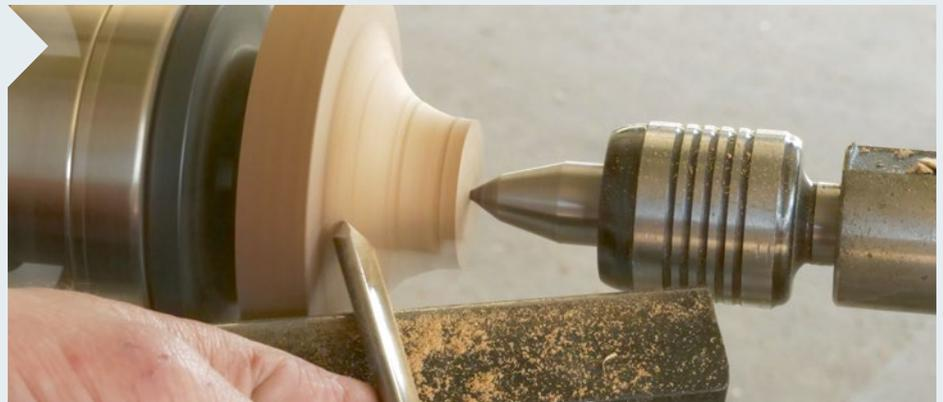
**11** Setzen Sie den Reitstock zur Sicherung ein, dann kann die Exzentrik beginnen. Die beim Drehen sichtbare „Luft-Holz-Mischung“ muss im ersten Schritt vollständig weg. Nehmen Sie eine 10-mm-Formröhre und dreheln Sie vorsichtig. Drehzahl: etwa 1.400 U/min.
