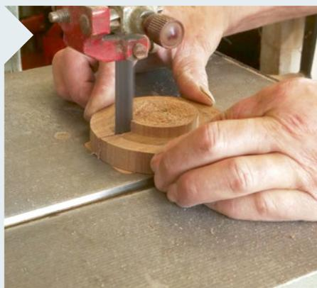
**5** Die Bandsäge schlitzt das Hilfsfutter nun ein: Schneiden Sie durch das ehemalige Schraubloch bis etwas über die Mitte der Deckelaufnahme.
