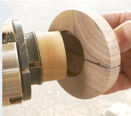
**8** Bringen Sie den Deckel außen genau aufs Maß der Bohrung im Hilfsfutter. Messen Sie diese, verlassen Sie sich nicht aufs Bohrer-Maß. Testen Sie mehrmals, so dass eine stramme Passung garantiert ist.
