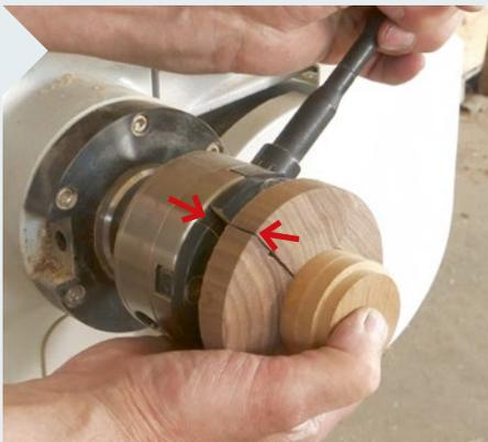
**10** Nun kommt das Hilfsfutter mit seinem Zapfen ins Spannfutter. Drehen Sie es so, dass der Schlitz zwischen zwei Backen liegt. Jetzt können Sie den Deckel-Rohling mit viel Kraft in dem für ihn vorbereiteten exzentrischen Loch spannen.
