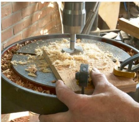
**1** Das exzentrische Spannen ohne Spezialfutter erfordert einige Vorbereitung: Bohren Sie zunächst in ein Rest-Brett ein 50-mm-Loch, 10 mm tief.
