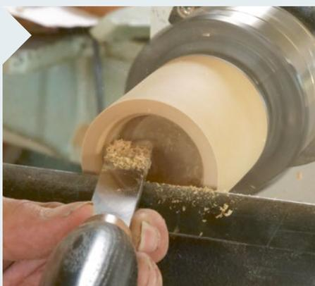
**16** | Der Falz ist etwa einen Millimeter tiefer als der Deckel dick ist. Ein Rundnasenschaber vollendet die 40 mm tiefe Innenform, dann wird geschliffen und (in diesem Fall) geölt.
