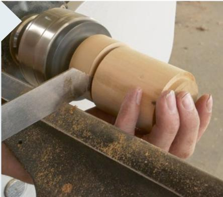
**7** Nehmen Sie den Rohling im Futter auf. Stechen Sie auf der linken Seite auf 25 mm Höhe (zuzüglich Zapfen) ab. Das lange, hier gerade abfallende Teil, wird die Dose. Im Futter verbleibt der Rohling für den Deckel.
