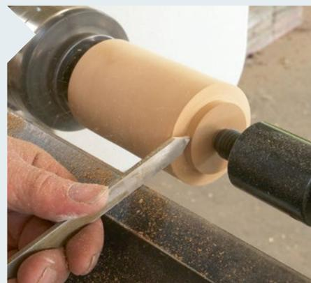
**6** Bereiten Sie nun den Birnbaum vor, indem Sie ihn zwischen den Spitzen rund schrumpfen. Dabei geht nur wenig Holz verloren. 63 mm ist hier der verbleibende Durchmesser. Drehen Sie dann auf beiden Seiten für die Aufnahme im Spannfutter einen Zapfen an.
