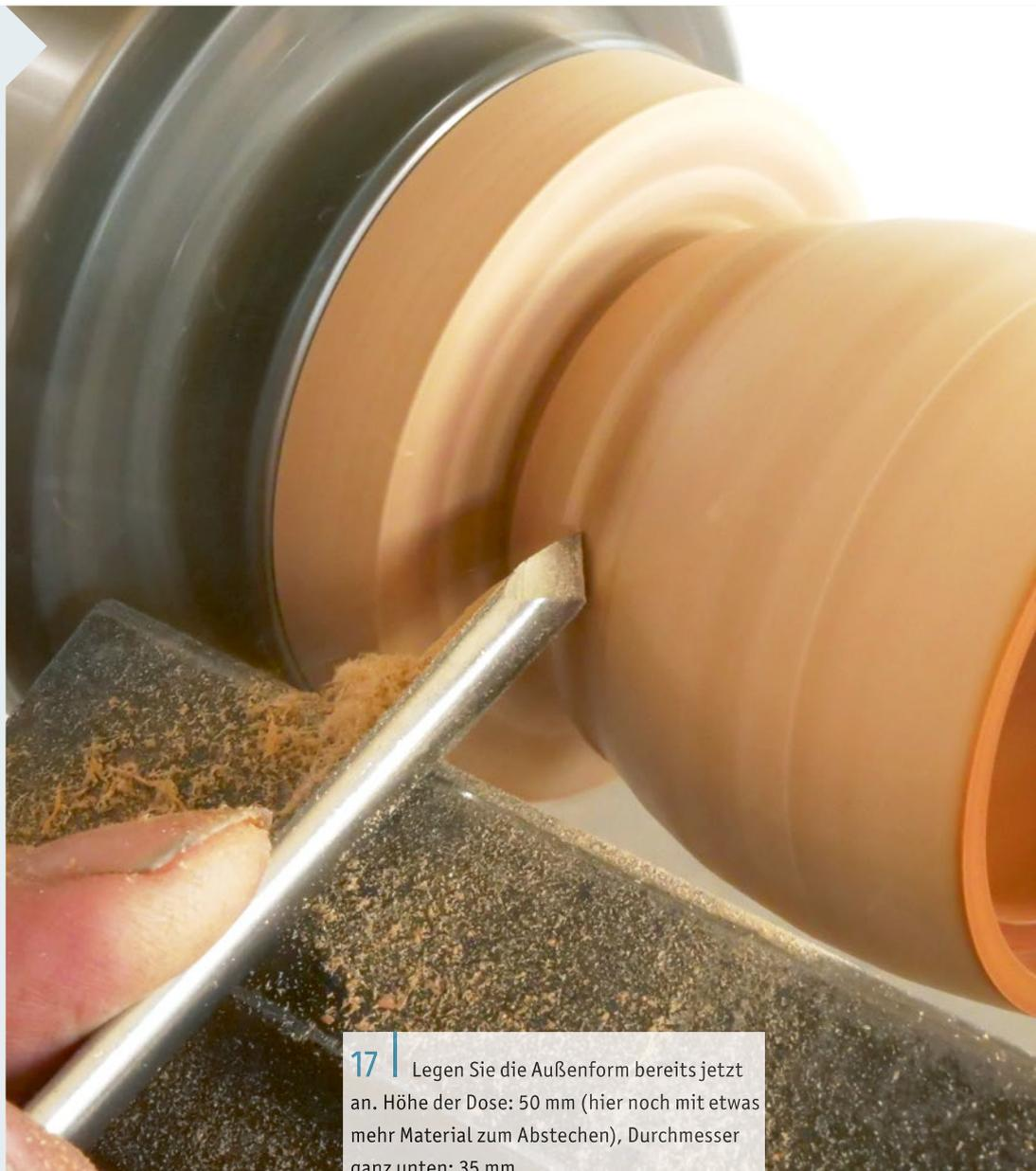
**17** | Legen Sie die Außenform bereits jetzt an. Höhe der Dose: 50 mm (hier noch mit etwas mehr Material zum Abstechen), Durchmesser ganz unten: 35 mm.
