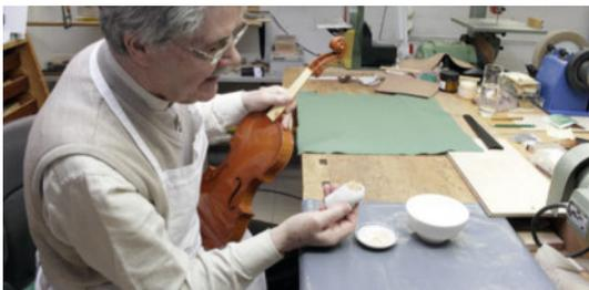
Mit dem feuchten Leinenballen wird das Tripelpulver angetupft.
