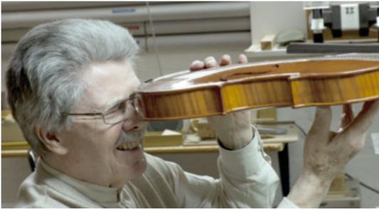
Blickt man durch die Bohrung für den Knopf in das Instrument, kann man überprüfen, ob die Stimme senkrecht steht.
