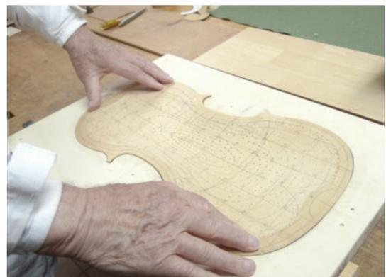
Das Werkstück wird beim Bearbeiten durch den Sperrholzrand im Ausarbeitungsblock gehalten.
