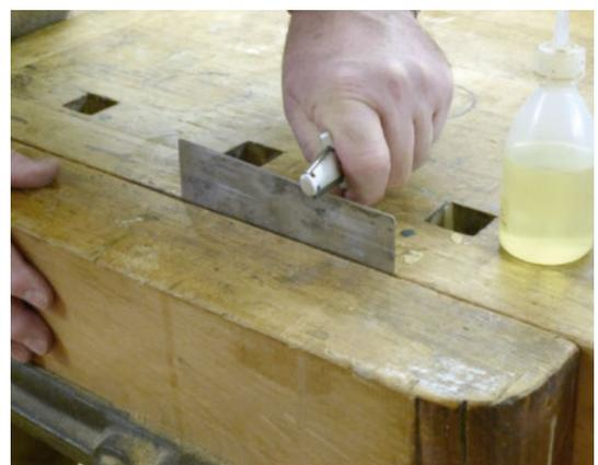
*Durch Druck wird das Material verformt, sodass sich ein Grat an der Ziehklingenkante bildet.*
