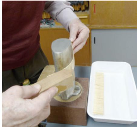
Der größere Radienbereich wird zuerst gebogen. Mit einem Druckstück, in diesem Fall aus Holz, wird das Werkstück gegen das Eisen gedrückt
