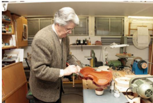
Mit einem Flachpinsel werden die einzelnen Lack-schichten aufgetragen. Der unbehandelte Hals dient als Griff, um das Instrument zu halten.
