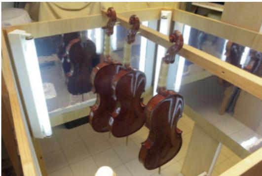
In einer Kammer wird der Lack unter UV-Licht ausgehärtet.
