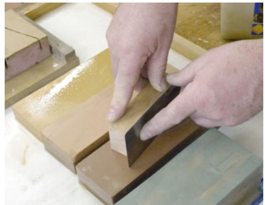
*Entstandene Feilriefen werden entfernt und die Kante mit japanischen Wassersteinen poliert.*
