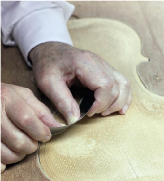
*Beim Schneiden mit der Ziehklinge entstehen feine Späne, die leicht entfernbar sind.*
