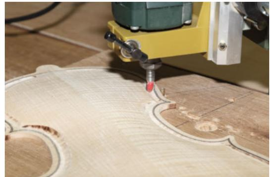
Mit einem Halbrundfräser wird die Hohlkehle parallel zum Aderungsverlauf vorgefräst.
