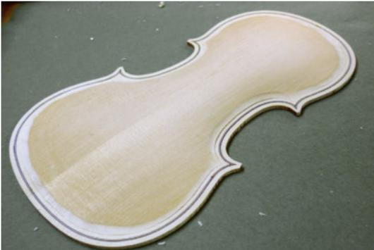
Eine umlaufende Hohlkehle wird in Decke und Boden ausgearbeitet,
