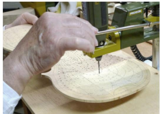
Entlang der aufgezeichneten Höhenlinien werden die Tiefenbohrungen eingebracht.
