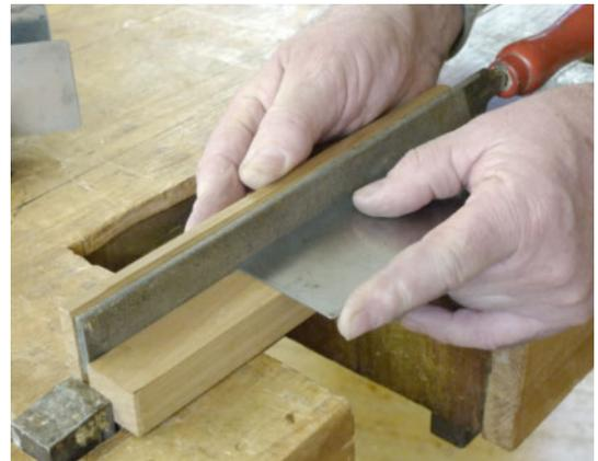
*Mit einer Feile wird der alte Grat entfernt.*
