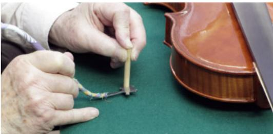
Mit dem Haken des Stimmsetzers kann die Stimme verschoben werden. Im Bild außerhalb des Instrumentes demonstriert.
