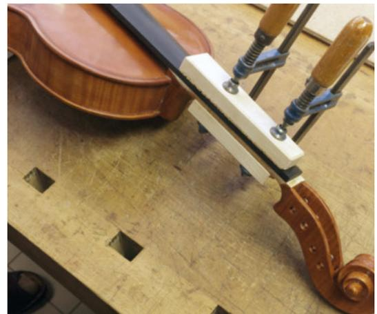
*Mit Schraubzwingen wird das Griffbrett angepresst, bis der Leim abgebunden hat.*
