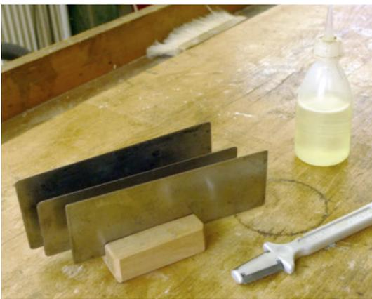
*Um den Schneidgrat nicht zu beschädigen, werden Ziehklingen in einem geschlitzten Holzklötz aufbewahrt. Rechts neben dem Klötz liegt der „Ziehklingenstahl“, mit dem der Grat hergestellt wird.*
