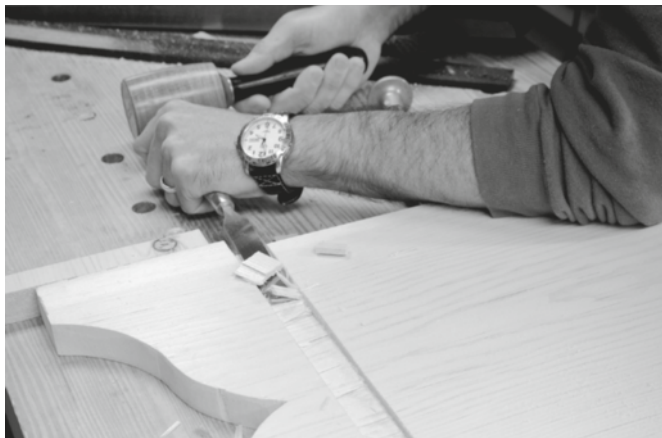
Abb. 4: Der Verschnitt in einer Nut wird zuerst mit oben liegender Fase des Stechbeitels entfernt.
