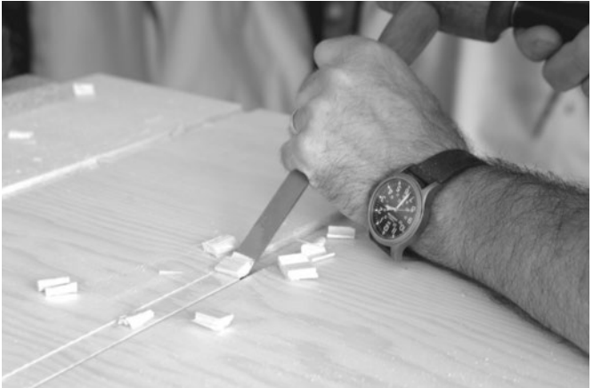
Abb. 5: Der restliche Verschnitt wird mit unten liegender Fase entfernt.
