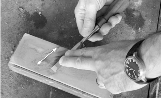
Abb. 52: Obwohl die Spiegelseite in etwa fünf Sekunden abgezogen werden kann, verbringe ich meist etwas mehr Zeit mit dem Abziehen, um die Spiegelseite sauber und auf Glanz poliert zu halten.
