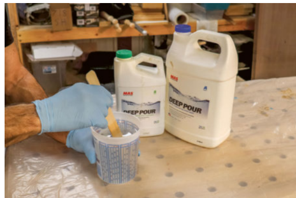
15 Mischen Sie Harz und Härter sorgfältig und genau nach Anweisung des Herstellers an.
