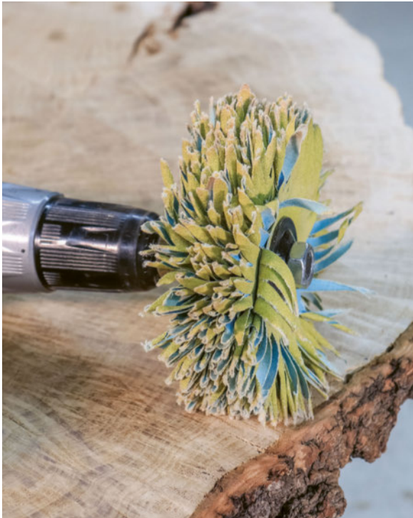
22 Ein Schleifmopp ist hervorragend geeignet, um Baumkanten zu säubern und glätten.
