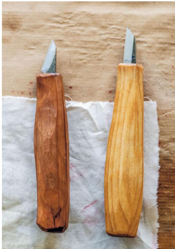
Die Kerbschnitzklinge ist kurz, zwischen 20 und 30 mm lang, und hat eine gerade Schneide. Der Griff ist etwa 110 mm lang und im Querschnitt oval, er ist am Rücken dicker als an der Unterseite. Er hat kleinere Abmessungen als bei einem Schnitzmesser. Auf dem Foto sind zwei Kerbschnitzmesser mit konkaven Fasen und verschiedenen Winkeln zwischen Schneide und Klingentrücken zu sehen
