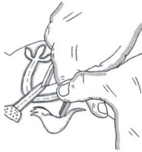
Der Gravurschnittgriff wird durch den Daumen der anderen Hand verstärkt. Die Kontur wird zuerst mit dem Geißfuß geschnitten. Mit dem Kerbschnitzmesser werden die Kanten zur Fläche hin vertieft. Um Kraft und Kontrolle zu haben sowie beim ersten Schnitt im 60-Grad-Winkel ausreichend Tiefe erreichen zu können, nimmst du den Daumen der anderen Hand zur Hilfe.
