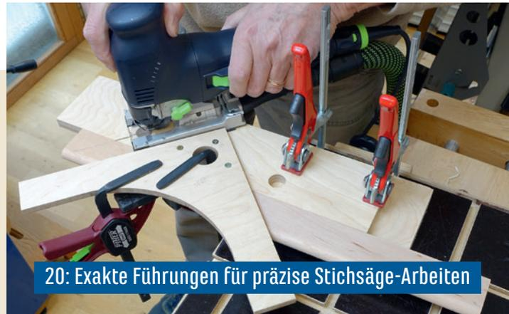
20: Exakte Führungen für präzise Stichsäge-Arbeiten
