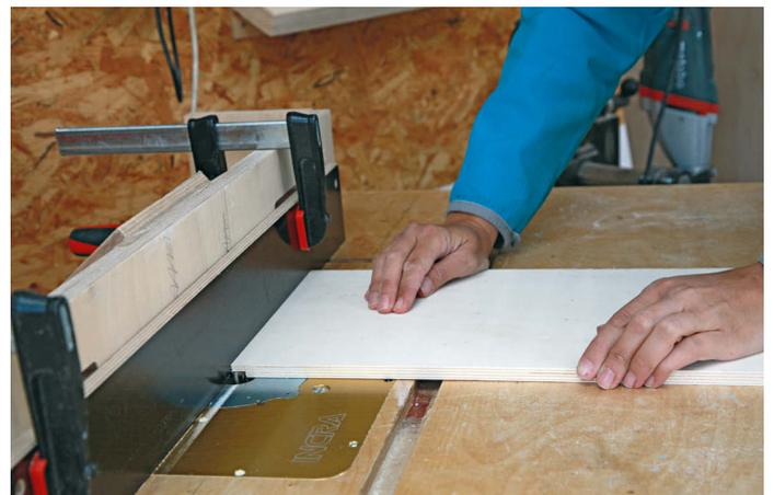
**1** | Beginnen Sie den Bau mit der äußeren Kiste. Ein 10-mm-Nutfräser fräst die Nuten und Falze in die Längsseiten und Mittelwand. Die Nuten sind symmetrisch, Sie können den Fräsanschlag also einmal einstellen und das Werkstück nach dem ersten Fräsdurchgang wenden.
